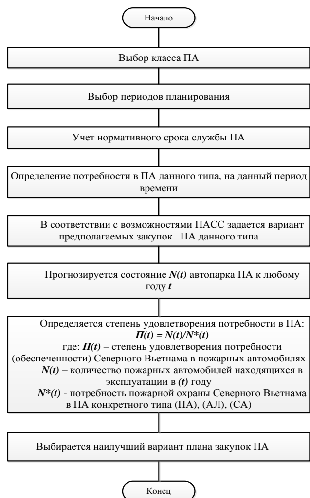
Рисунок 21 – Линейный алгоритм планирования закупок для покрытия потребности в основных и специальных ПА
