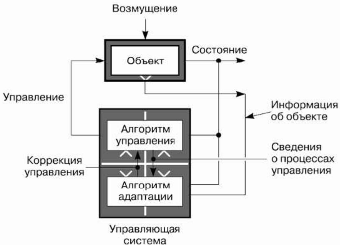
Рисунок 2.5 – Схема системы с адаптацией
