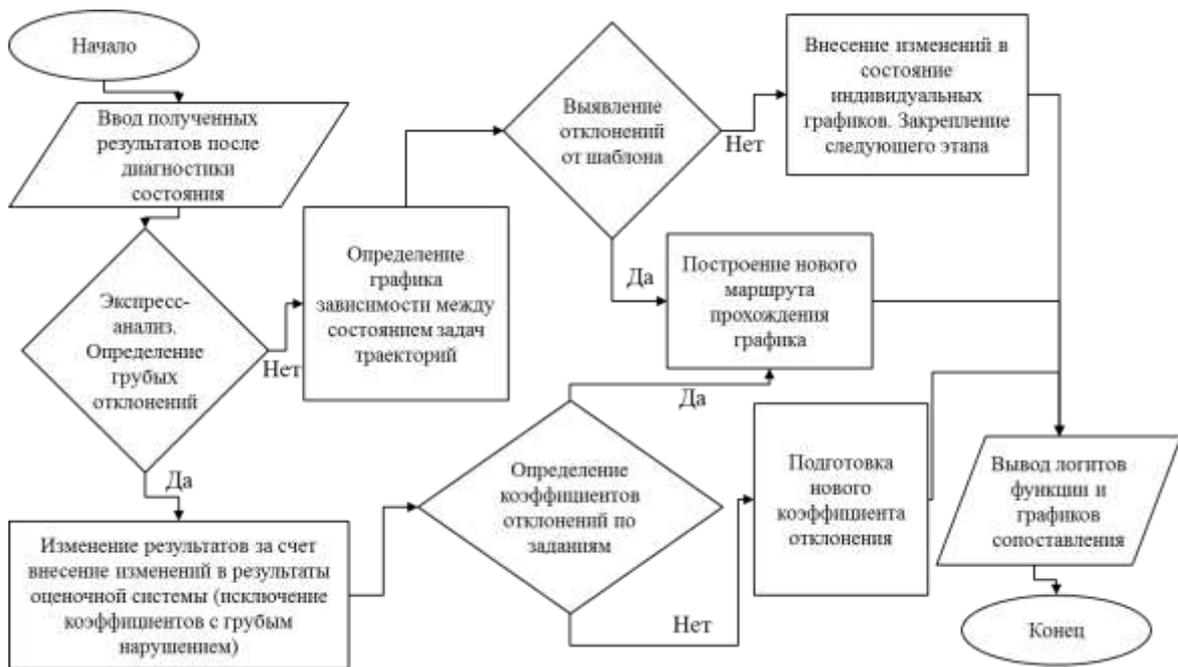
Рисунок 3.3 – Блок-схема алгоритма корректировки обратной связи
