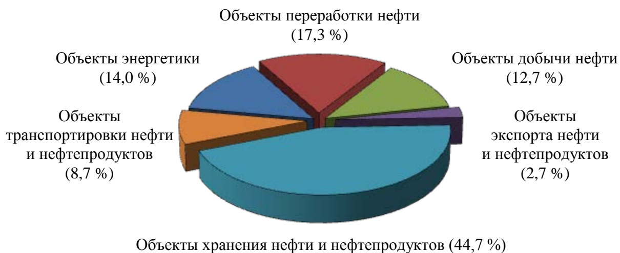
Рис. 1.3. Распределение разрушившихся РВС по объектам ТЭЖ
