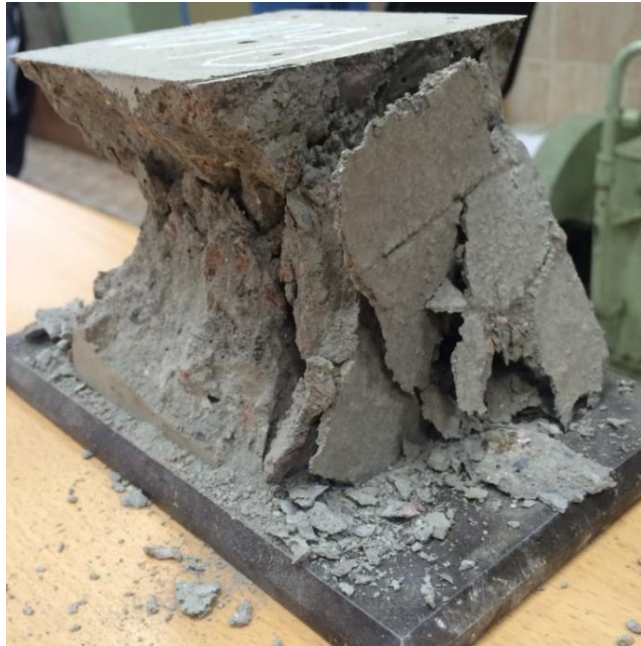
Рисунок 2.10 – Образец из бетона с добавкой ProZASK IGS 12 мм после проведения эксперимента
