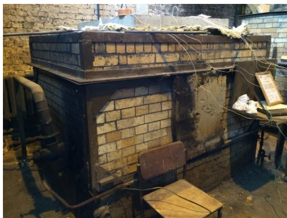
Рисунок 3.1 – Малая горизонтальная огневая печь для исследования теплофизических характеристик
