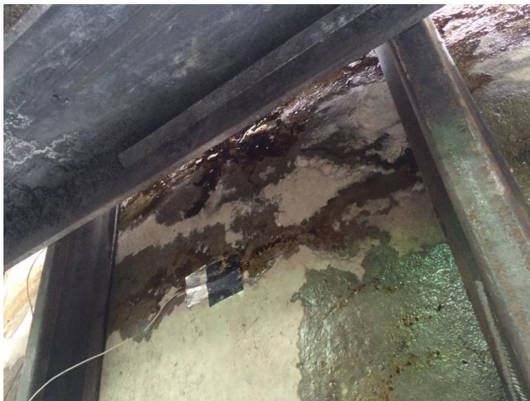
Рисунок 4.23 – Выпаривание влаги на 100 минуте при испытаниях на огнестойкость в месте воздействия вертикальной нагрузки
