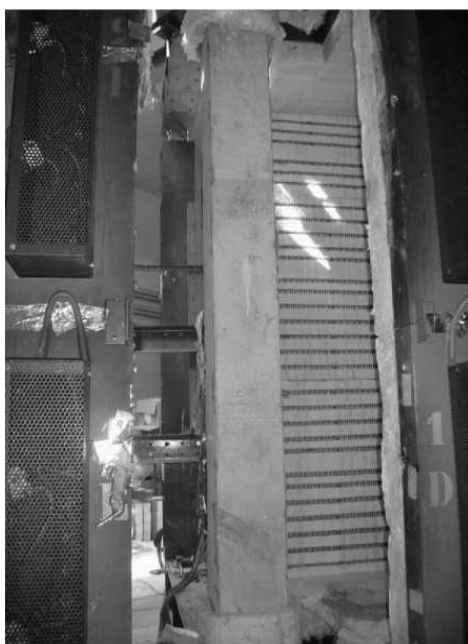
Рисунок 1.23 – Колонна С1 после испытания [127]
