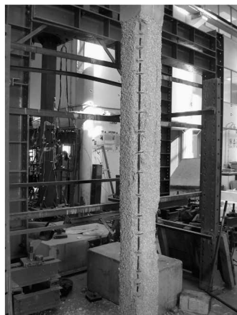
Рисунок 1.24 – Колонна С4 после испытания [127]
