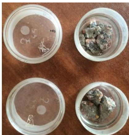
Рисунок 3.8 – Бюксы для сушки бетона с образцами в сушильных шкафах
