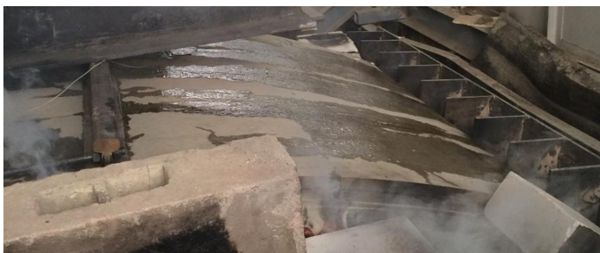
Рисунок 4.22 – Выпаривание влаги на 100 минуте при испытаниях на огнестойкость
