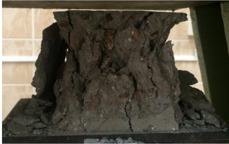
Рисунок 2.9 – Образец из бетона без добавки фибры после проведения эксперимента
