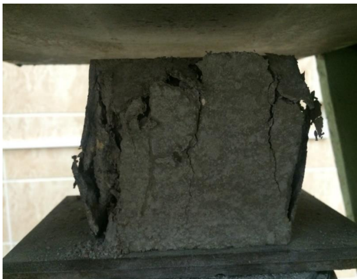
Рисунок 2.8 – Образец из бетона с добавкой полипропиленовой фибры после проведения эксперимента
