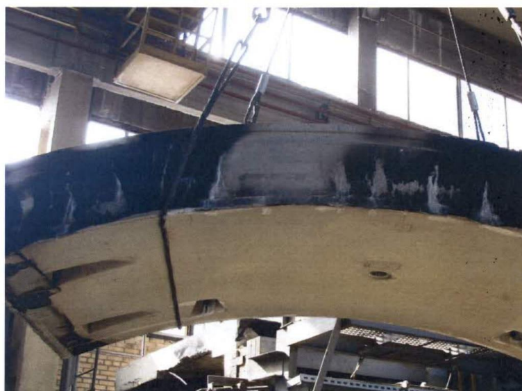
Рис. 6. Опытный образец № 2 после огневого воздействия, вид на обогреваемую сторону, повреждений защитного слоя бетона не зафиксировано
