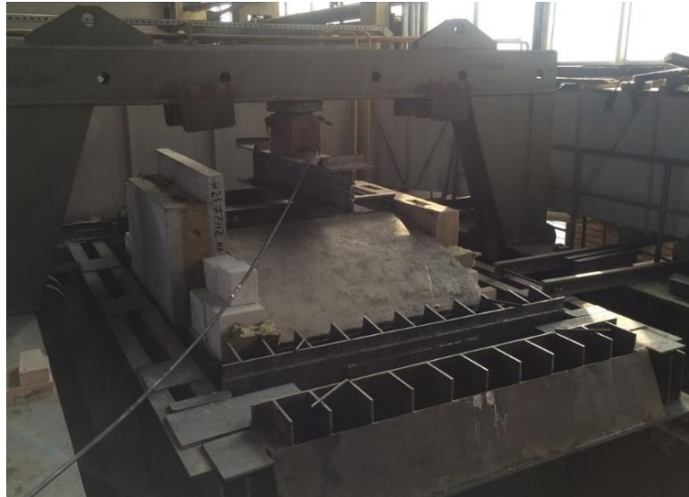
Рисунок 4.7 – Крупномасштабная горизонтальная огневая печь с системой нагружения тубингов
