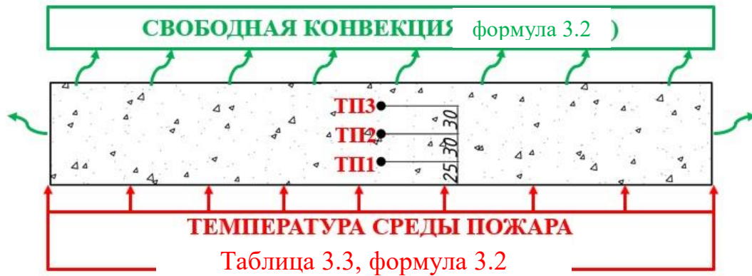
Рисунок 3.18 – Расчётная модель плиты для определения теплофизических характеристик
