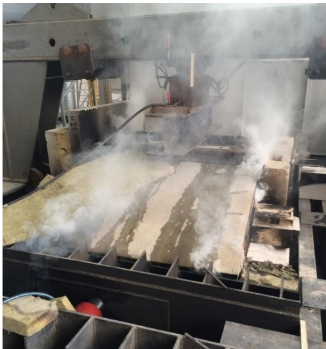
Рисунок 4.21 – Выпаривание влаги на 40 минуте при испытаниях на огнестойкость
