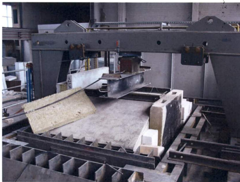
Рис. 2. Опытный образец железобетонного блока тоннельной обделки, установленный на огневую камеру испытательной установки с приложенной статической нагрузкой в соответствии с проектно-расчетной схемой. На фотографии представлена система распределения нагрузки, гидравлический домкрат системы нагружения и стальная рама для восприятия нагружающего усилия.
