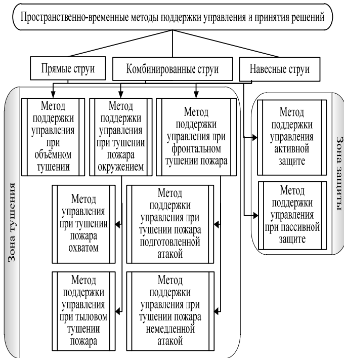
Рисунок 23 – Формализованный метод поддержки управления при ведении ОТД ПП для тушения пожара с учетом способа подачи ОВ
