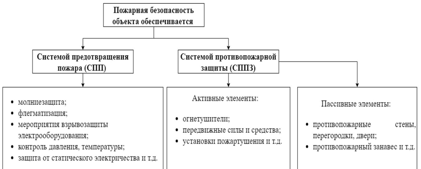
Рисунок 2.28 – Структурная схема системы обеспечения пожарной безопасности объекта защиты
