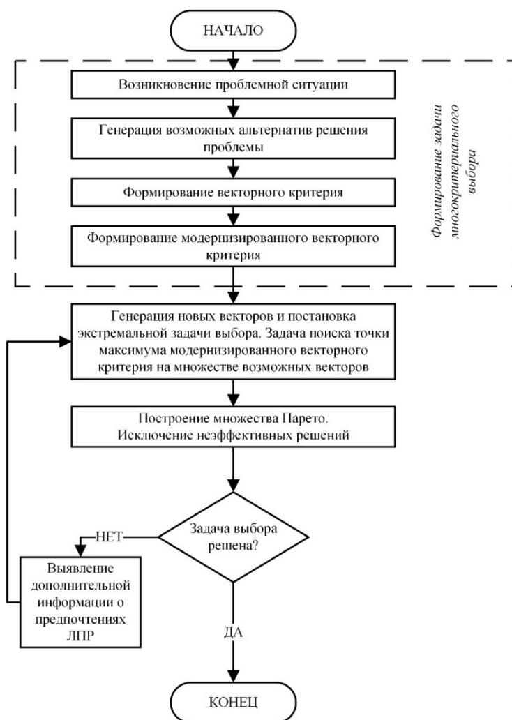
Рисунок 3 – Алгоритм поддержки принятия решений при выборе способов использования мобильных средств мониторинга
