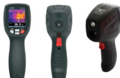
Рисунок 37 - Тепловизор СЕМ DT-870
