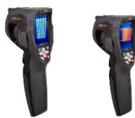
Рисунок 94 - Тепловизор RGK TL-80
