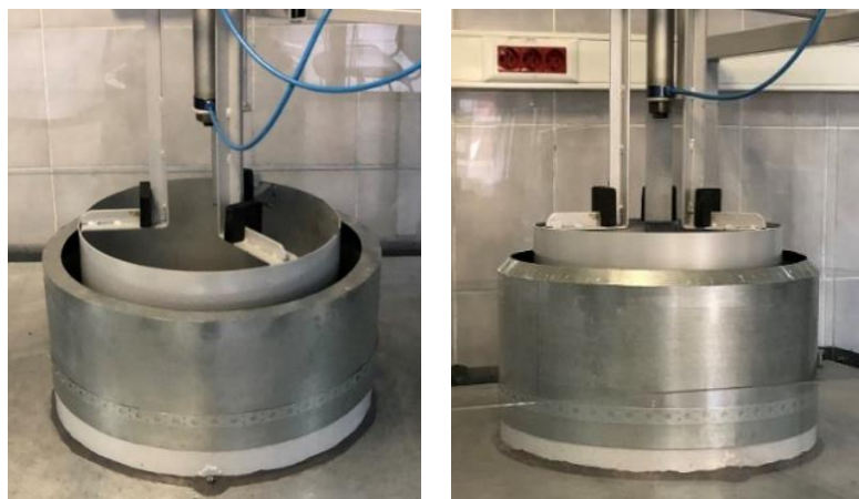
Рисунок 9 – Общий вид лабораторного стенда для нахождения необходимой высоты защитной стенки РВСЗС в зависимости от ее удаленности от стенки резервуара и длины вылета ГВК ( a ) или НВК ( б )
