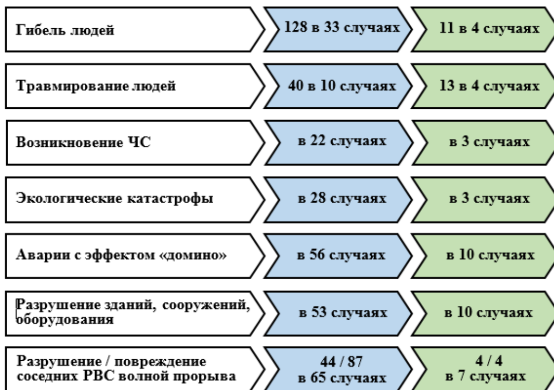
Рисунок 2 – Последствия 156 случаев разрушений РВС на объектах ТЭК России (синий цвет) за период с 1951 по 2022 гг., в том числе 23 случаев – на объектах энергетики (зеленый цвет) за период с 1971 по 2022 гг.
