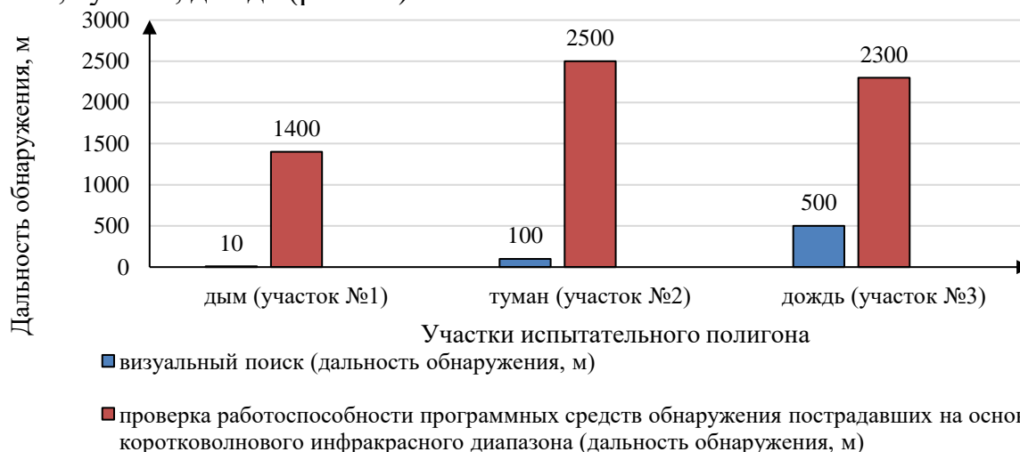
Рис. 23 – Результаты измерений на трёх участках испытательного полигона МОБ Вьетнама в г. Хоабинь
