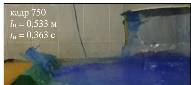
Рисунок 4 – Характерные кадры видеосъемки разрушения резервуара в масштабе 1:30 к натурному РВС-700 м 3 в соответствующие моменты времени
