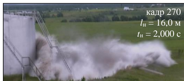
Рисунок 1 – Характерные кадры видеосъемки полного разрушения РВС-700 м 3 с водой в соответствующие моменты времени
