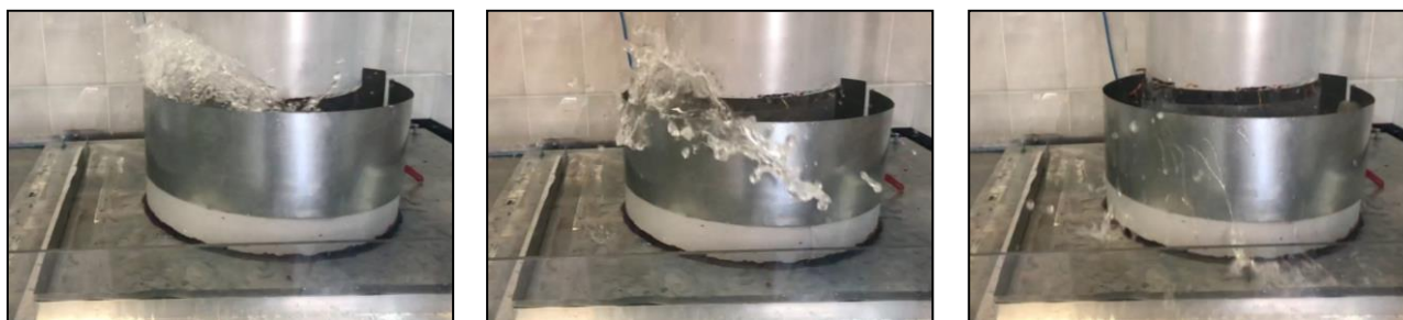
Рисунок 8 – Характерные кадры взаимодействия потока жидкости, образующегося при разрушении внутреннего резервуара, с защитной стенкой РВСЗС высотой 0,9h_0
