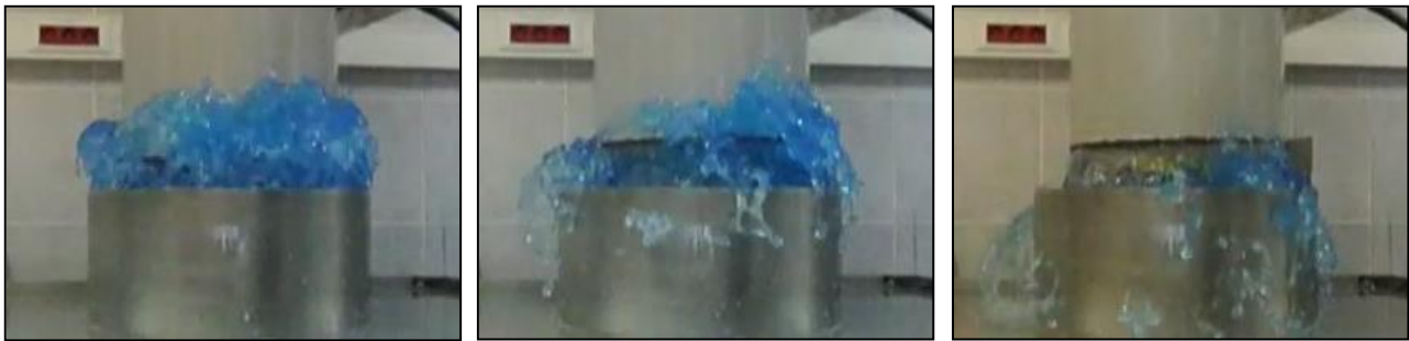
Рисунок 6 – Характерные кадры взаимодействия потока жидкости при разрушении резервуара в масштабе 1:30 к натурному РВС-700 м 3 с защитной стенкой, установленной на расстоянии 0,07 м (2,1 м для натурного объекта)
