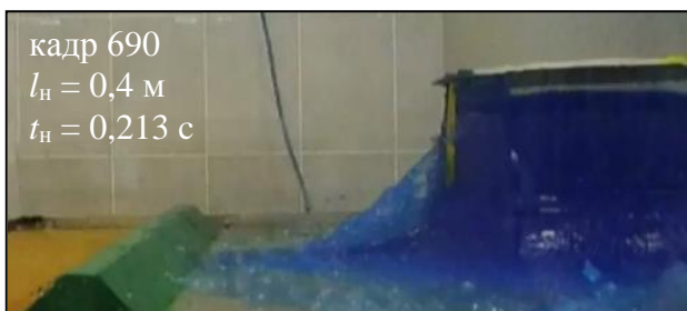
Рисунок 4 – Характерные кадры видеосъемки разрушения резервуара в масштабе 1:30 к натурному РВС-700 м 3 в соответствующие моменты времени
