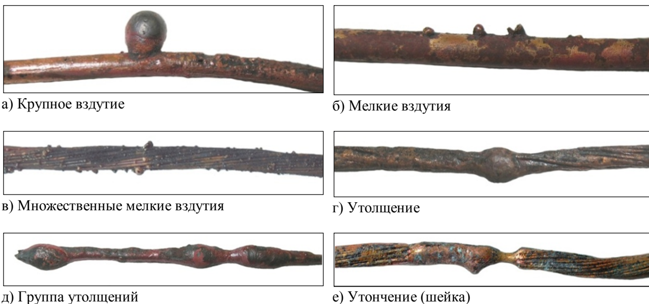
Рисунок 2 – Следы, образующиеся на поверхности медных проводников в результате токовой перегрузки кратностью свыше 3 \div 4 (сечение проводников – 2,5 \text{ мм}^2 )
