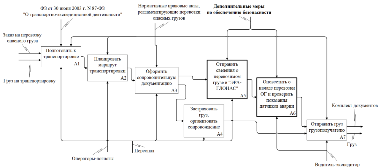
Рисунок 6 – Реинжиниринг системы управления транспортной логистикой опасных грузов с предлагаемыми дополнительными мерами обеспечения безопасности
