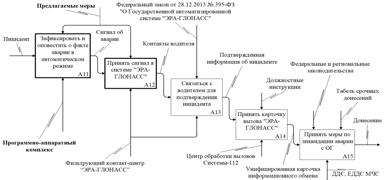
Рисунок 7 – Информирование ЛПР с помощью программно-аппаратного комплекса
