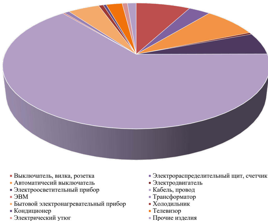
Рисунок 1.6 – Диаграмма распределения числа пожаров от электротехнических изделий за период с 2009 по 2020 гг.
