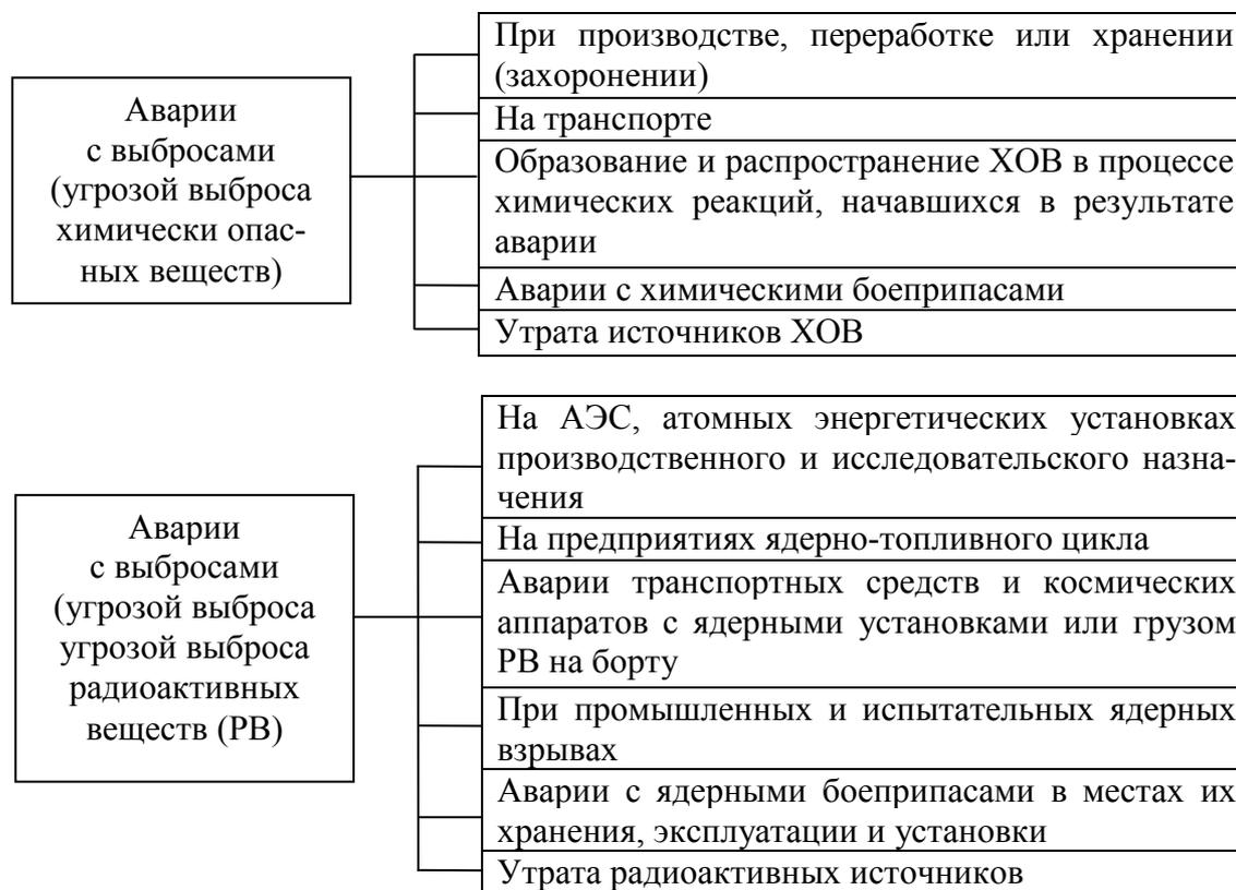
Рис. 1. Классификация аварий с выбросами химически опасных и радиоактивных веществ.
