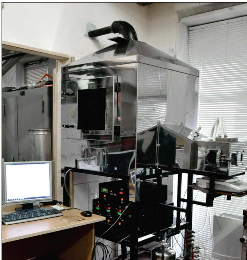
Рисунок 3.7 – Общий вид установки для определения пожарной опасности веществ и материалов при их термическом разложении
