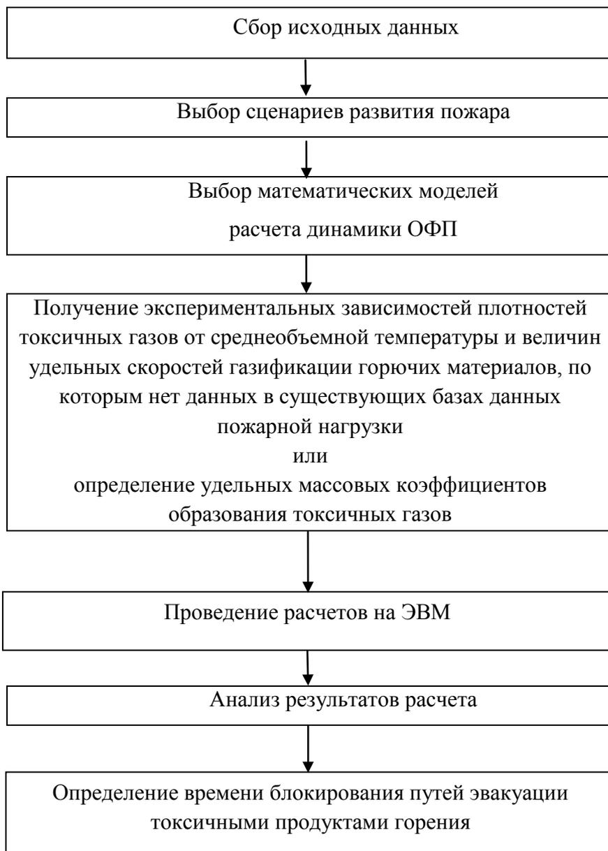
Рисунок 2.4 – Блок-схема методики расчета распространения токсичных газов при пожаре
