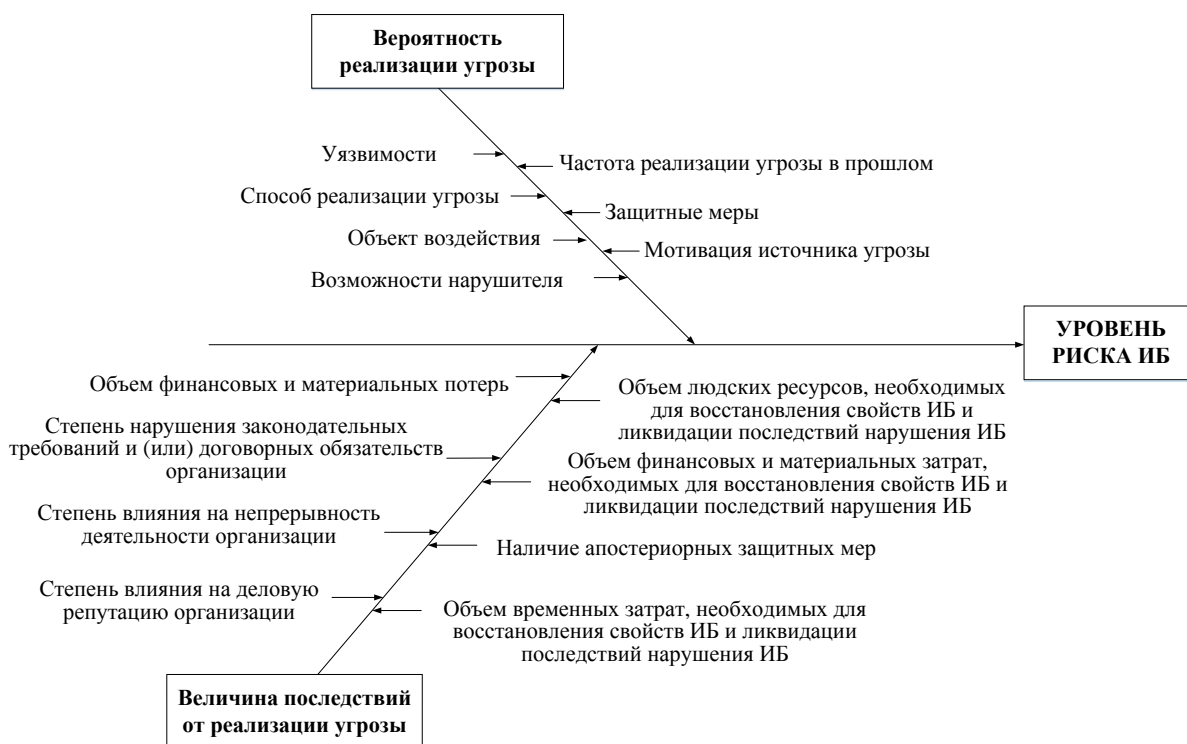
Рис. 1. Причинно-следственная связь факторов, влияющих на уровень риска нарушения информационной безопасности
