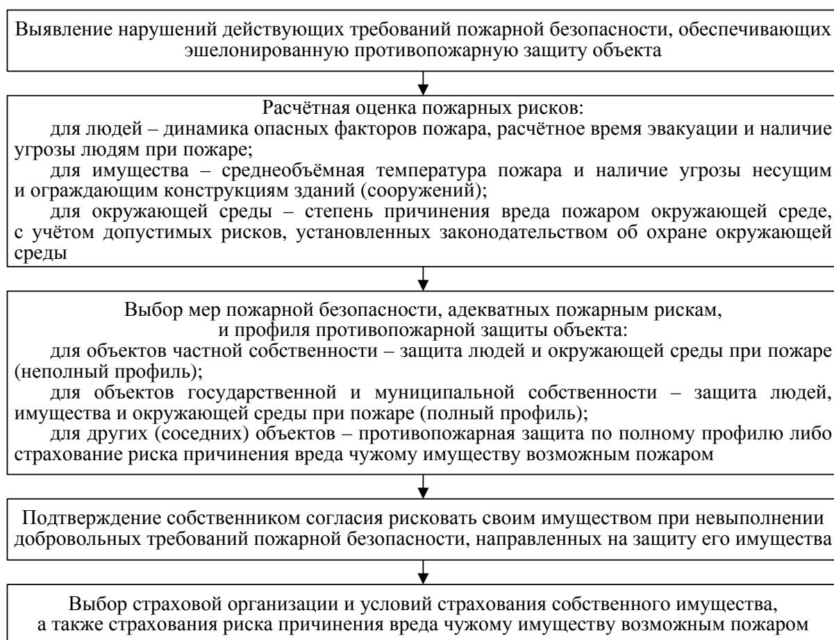
Рис. 1. Блок-схема алгоритма применения действующих требований пожарной безопасности
