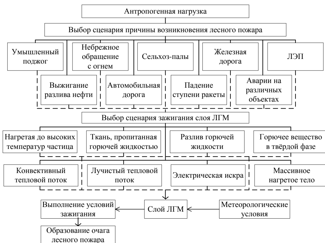
Рис. 1. Механизм возникновения лесного пожара в результате антропогенного воздействия (нагрузки) [3]
