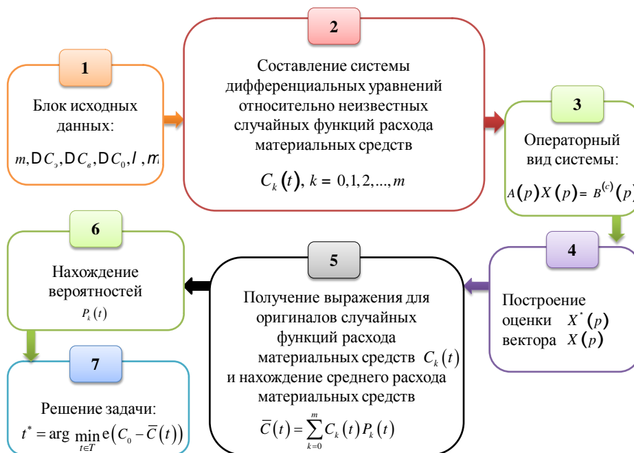
Рис. 1. Блок-схема алгоритма расчёта остаточного ресурса СПА:
