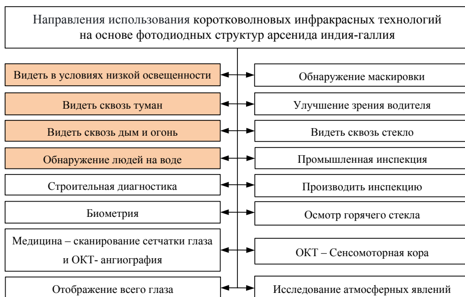
Рис. 2. Направления использования коротковолновых инфракрасных технологий на основе фотодиодных структур арсенида индия-галлия
