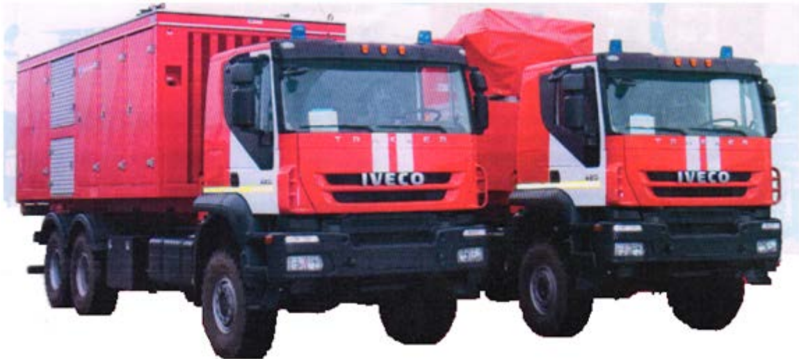
Рис. 4. Универсальный насосно-рукавный комплекс высокой производительности "Шквал"
