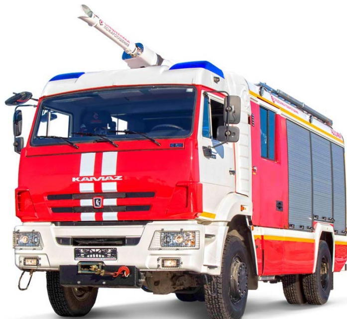
Рис. 3. Автоцистерна пожарная АЦ-3,2-40/4 Камаз 43253
