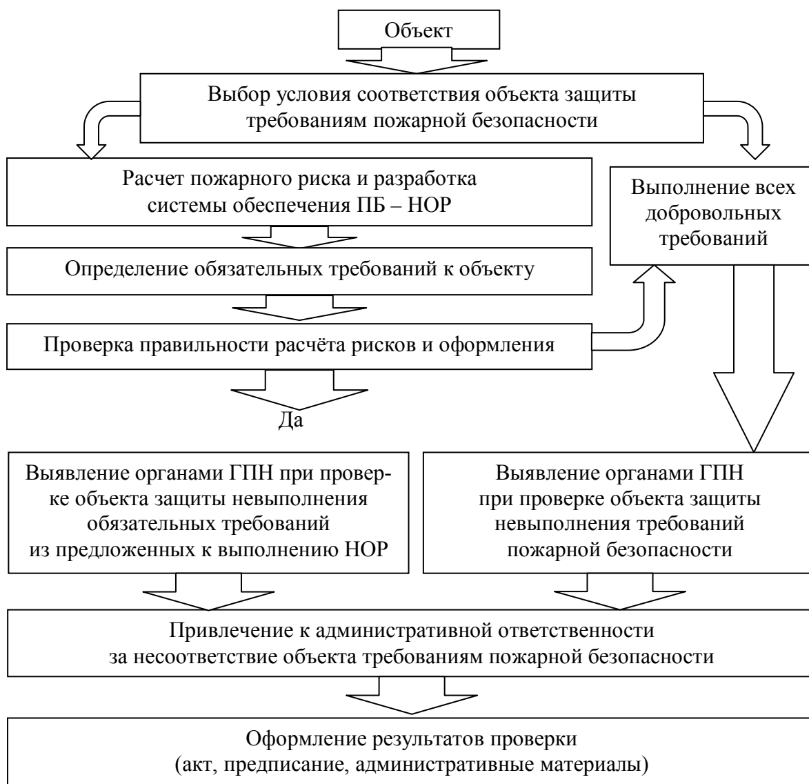
Рис. 2. Блок-схема алгоритма риск-ориентированного подхода по проверке обеспечения пожарной безопасности
