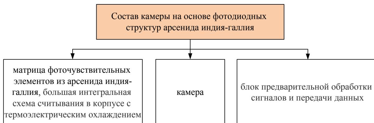
Рис. 4. Состав камеры на основе фотодиодных структур арсенида индия-галлия
