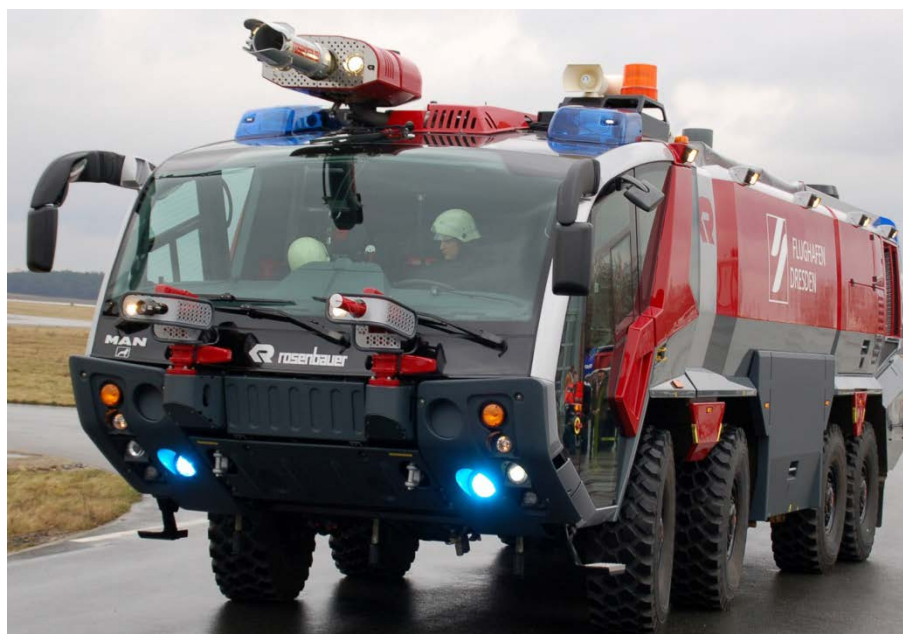
Рис. 2. Пожарный аэродромный автомобиль "Пантера" фирмы "Rosenbauer"
