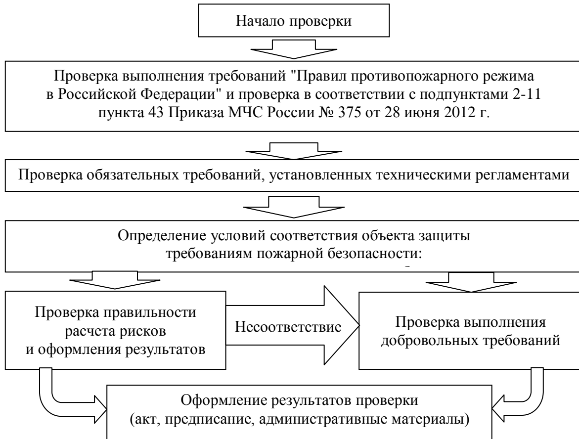
Рис. 1. Блок-схема алгоритма проверки обеспечения пожарной безопасности
