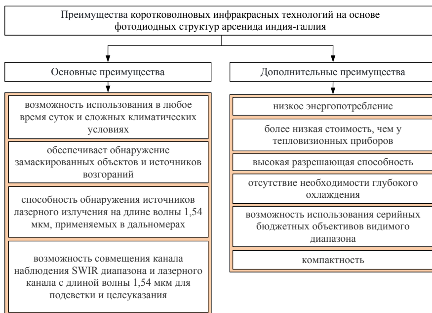
Рис. 1. Основные и дополнительные преимущества коротковолновых инфракрасных технологий на основе фотодиодных структур арсенида индия-галлия
