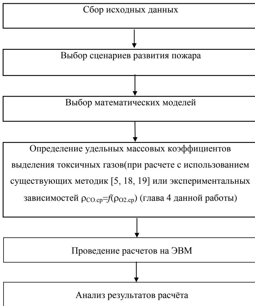
Рисунок 2.6. Блок-схема методики проведения расчётов
