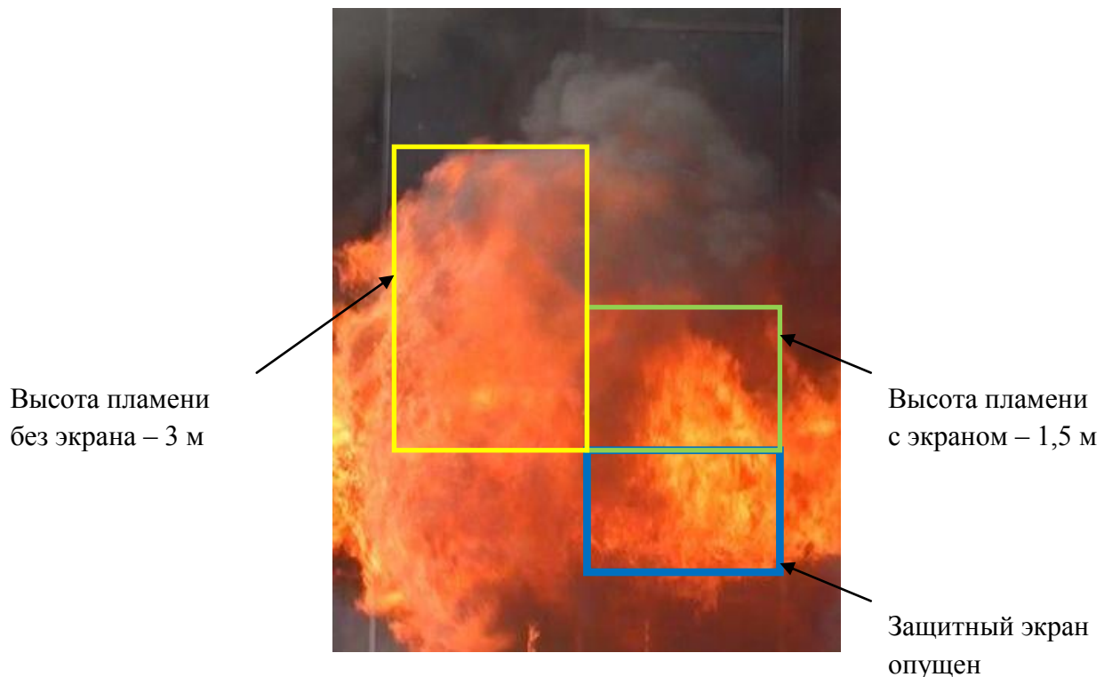
Рисунок 4.11 – Фиксация высоты пламени при опущенном защитном экране
