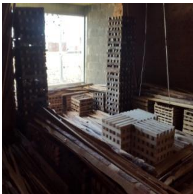
Рисунок 3.3 – Помещение очага пожара и характер размещения горючей нагрузки в помещении
