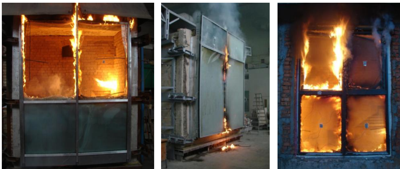
Рисунок 1.13 – Огневые испытания светопрозрачной конструкции
