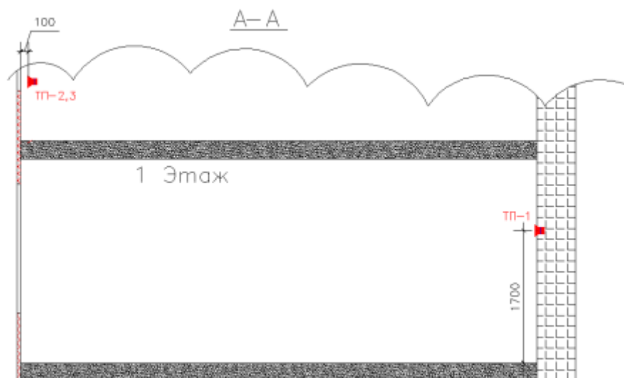
Рисунок 3.8 – Схема расстановки приемников тепловых потоков
