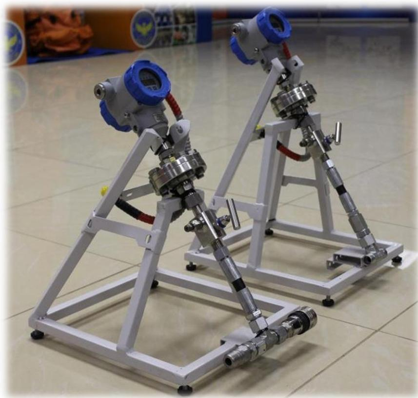
Рисунок 3.5 – Рукавные вставки с разделителями сред, клапанными блоками и датчиками давления
