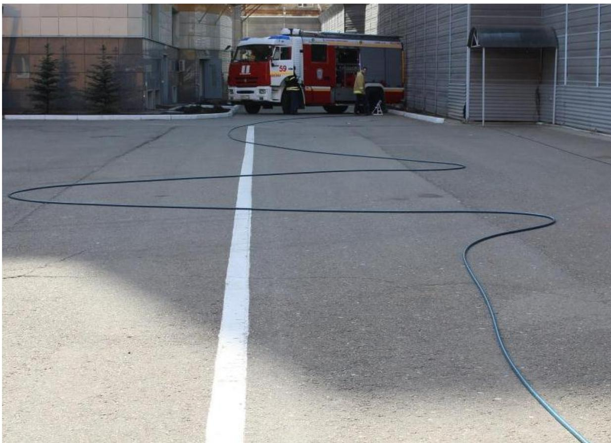
Рисунок 3.12 – Оценка влияния кривизны рукавной линии на гидравлические потери напора
