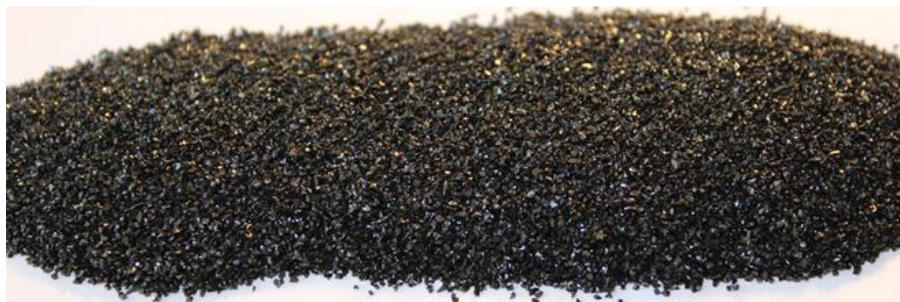
Рисунок 2.3 – Абразивный материал, применяемый для резки конструкций
