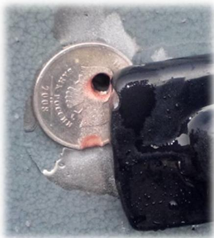
Рисунок 2.5 – Размер входного отверстия при точечной резке
