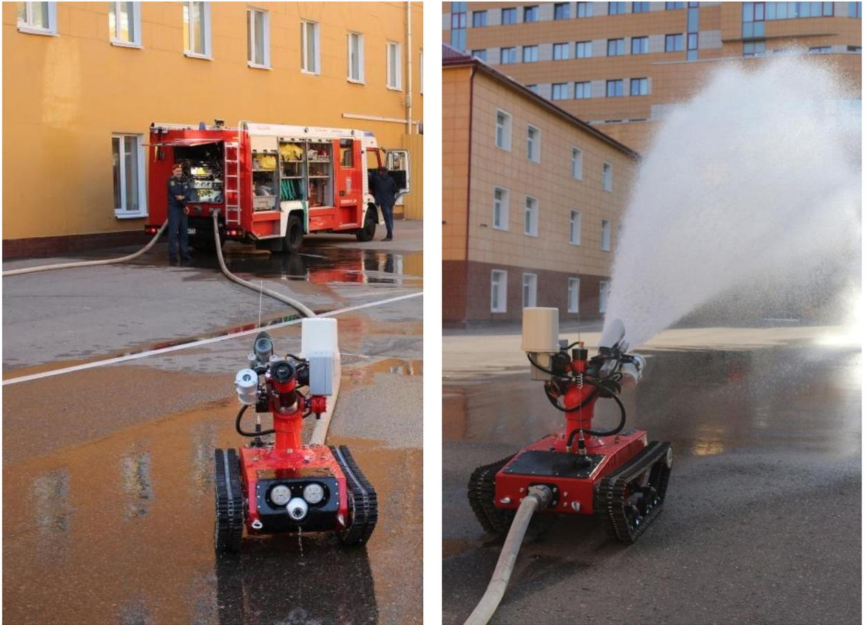
Рисунок 4.4 – Проверка работоспособности МРУП при подаче огнетушащих веществ
