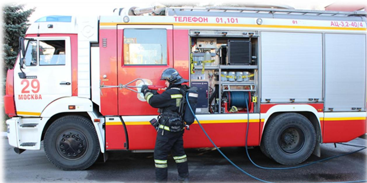
Рисунок 2.7 – АЦ-3,2-40/4 с установкой пожаротушения «Кобра»
