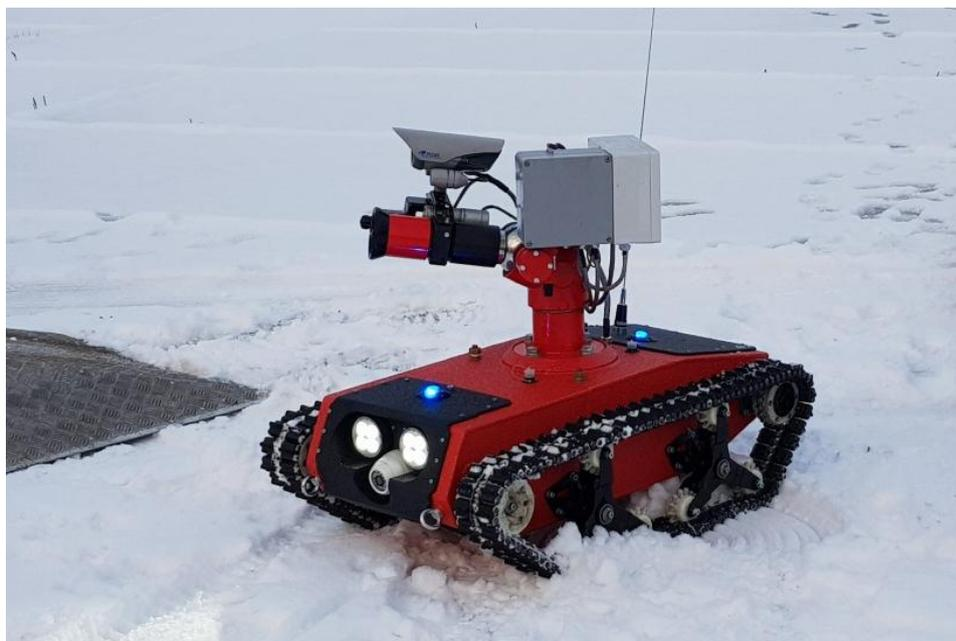
Рисунок 4.7 – Мобильная роботизированная установка пожаротушения
