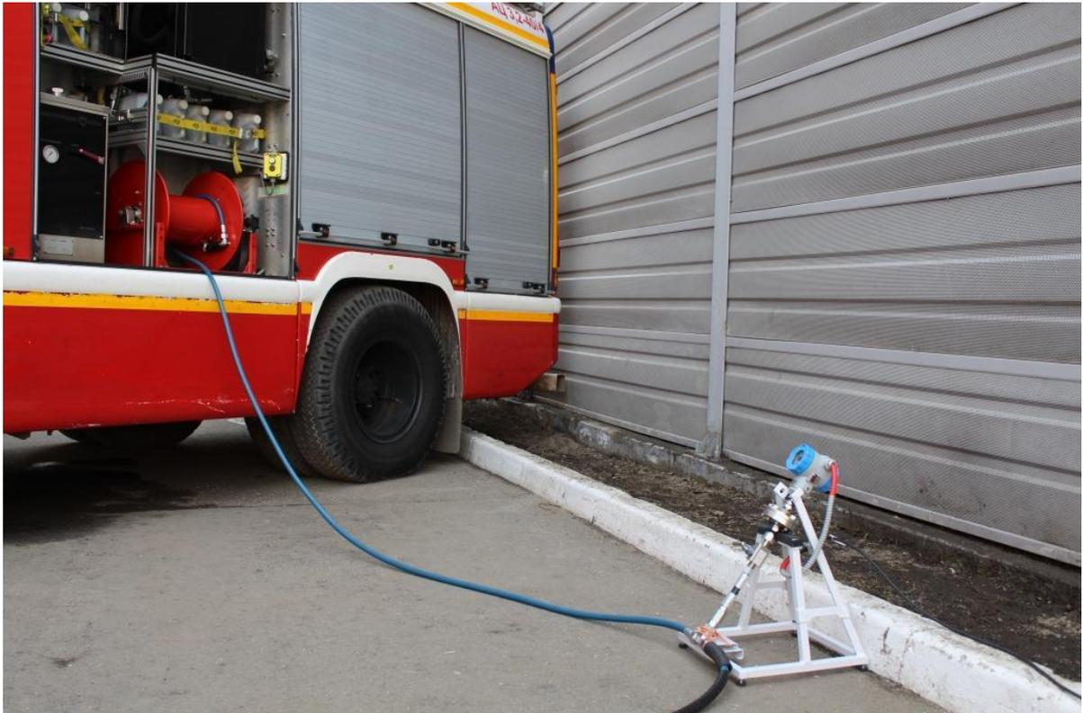
Рисунок 3.11 – Рукавная вставка для измерения избыточного давления перед входом в рукавную линию
