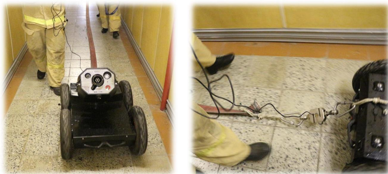
Рисунок 2.16 – Замеры возникающей силы трения на плиточном покрытии
