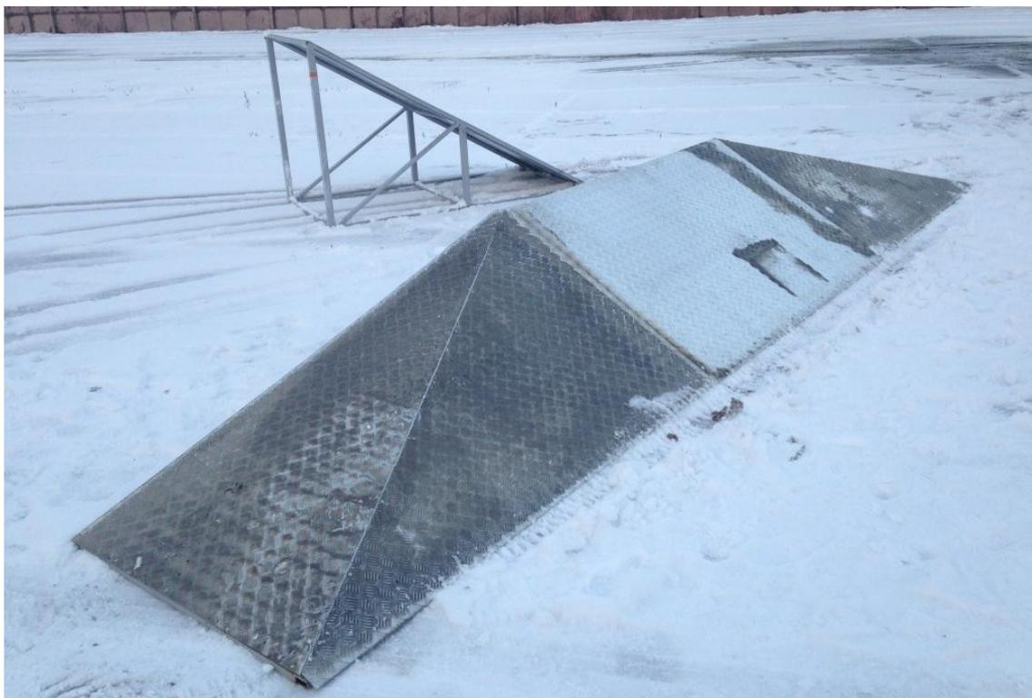
Рисунок 4.5 – Стенд для испытания ходовых качеств МРУП
