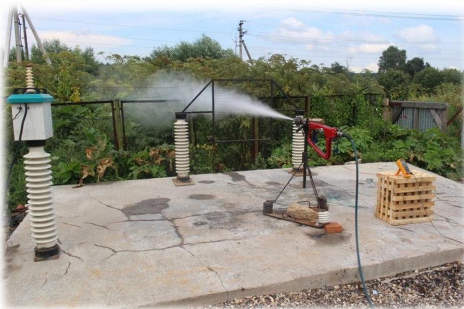
Рисунок 2.9 – Определение тока утечки по струе огнетушащего вещества на расстоянии 2 м при напряжении на мишени равном 30 кВ
