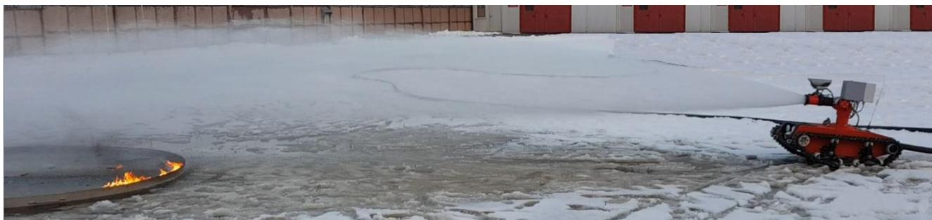
Рисунок 4.6 – Тушение модельного очага МРУП
