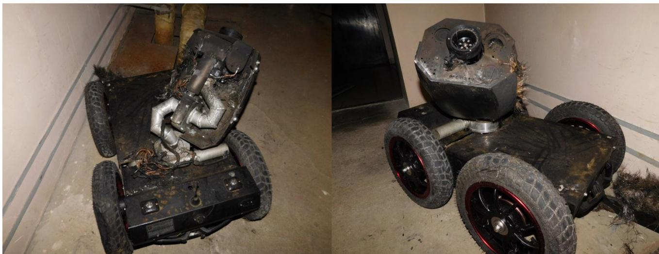
Рисунок 1.15 – Повреждения мобильной установки пожаротушения, полученные при тушении пожара
