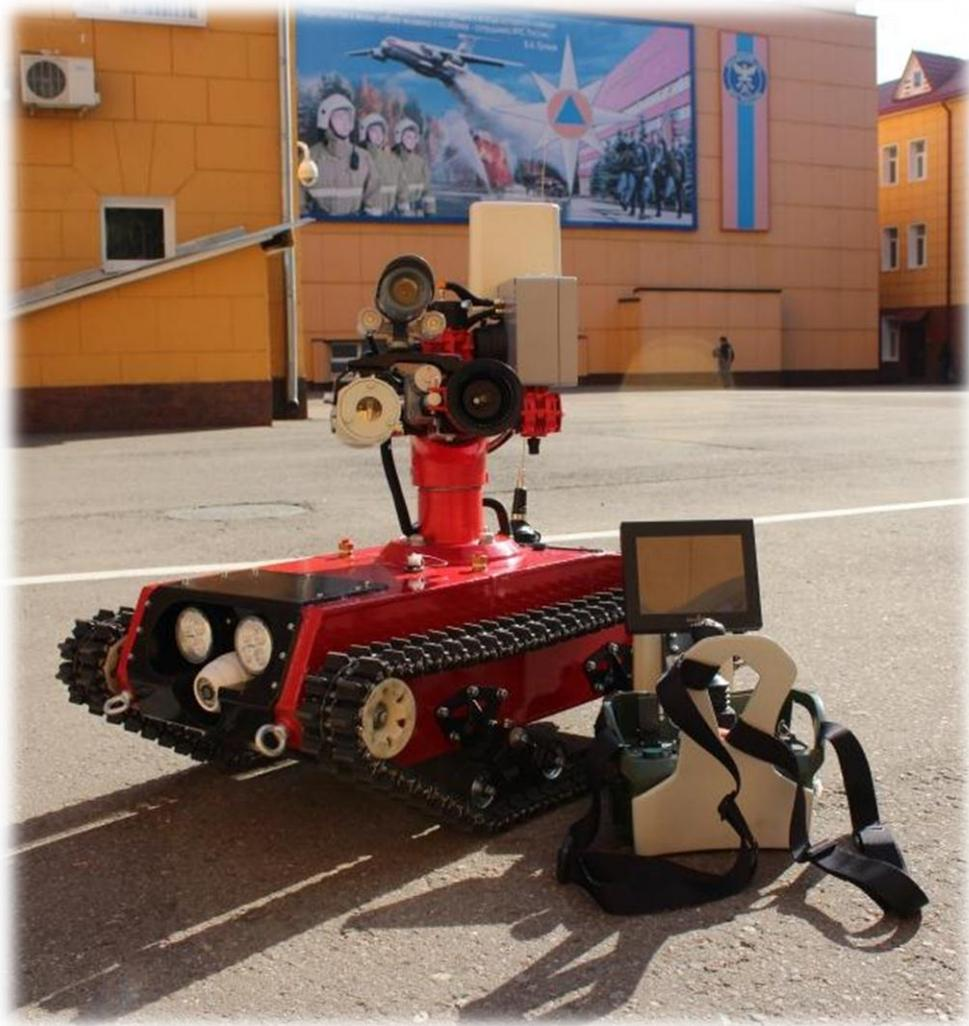
Рисунок 4.3 – Мобильная роботизированная дистанционно-управляемая установка пожаротушения
