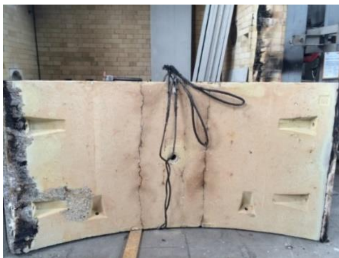
Рисунок 9 – Обогреваемая сторона железобетонного тюбинга после испытаний.
