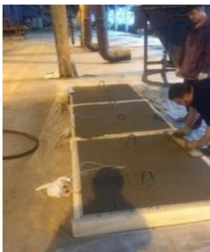
Рисунок 3 – Общий вид плит для исследования теплофизических характеристик
