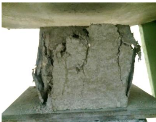
Рисунок 2 – Образец из бетона с добавкой ППФ после проведения эксперимента
