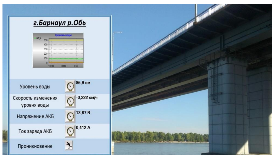
Рис. 3. Автоматический гидропост, установленный на автомобильном мосту через реку Обь в г. Барнауле
