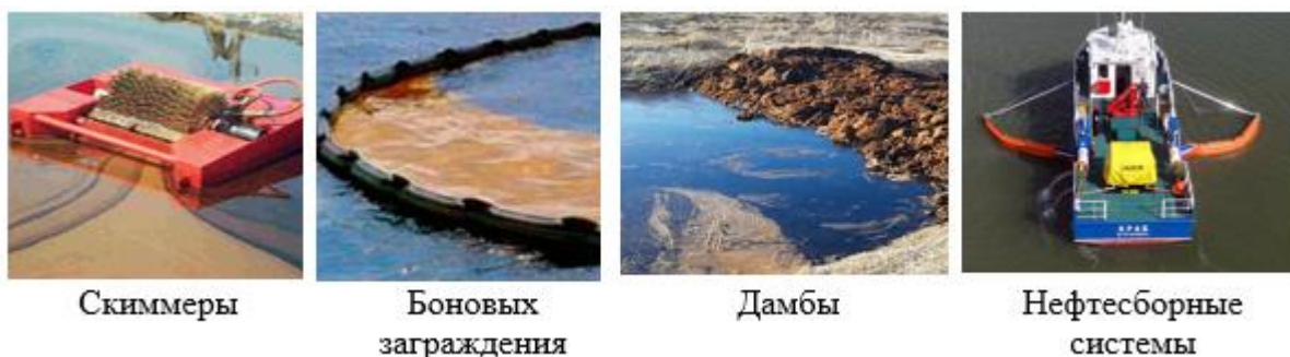
Рис. 3. Механические методы сбора нефтепродуктов
