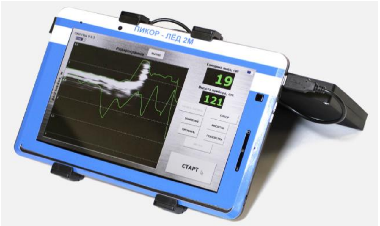
Рисунок 2.17 - Многофункциональный портативный радар для измерения толщины льда «Пикор-Лёд»
