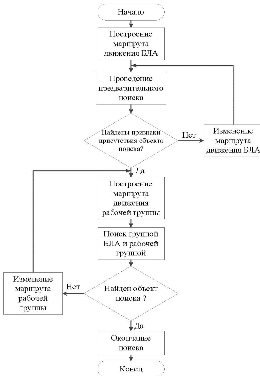
Рисунок 3.8 – Блок-схема алгоритма проведения ПСО при использовании БЛА
