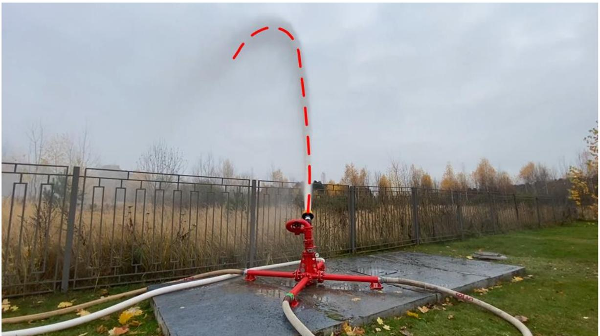
Рисунок 2.38 – Подаваемая струя при работе осциллирующего устройства с лафетным стволом
