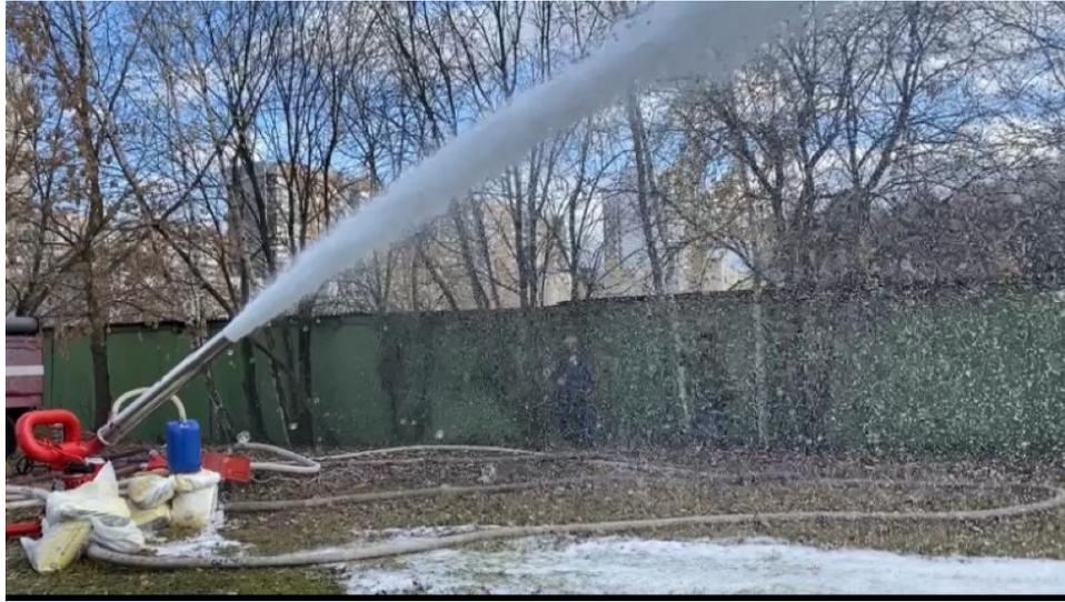
Рисунок 2.29 – Лафетный ствол с воздушно-пенным насадком, имеющим расход раствора пенообразователя 80 л/с
