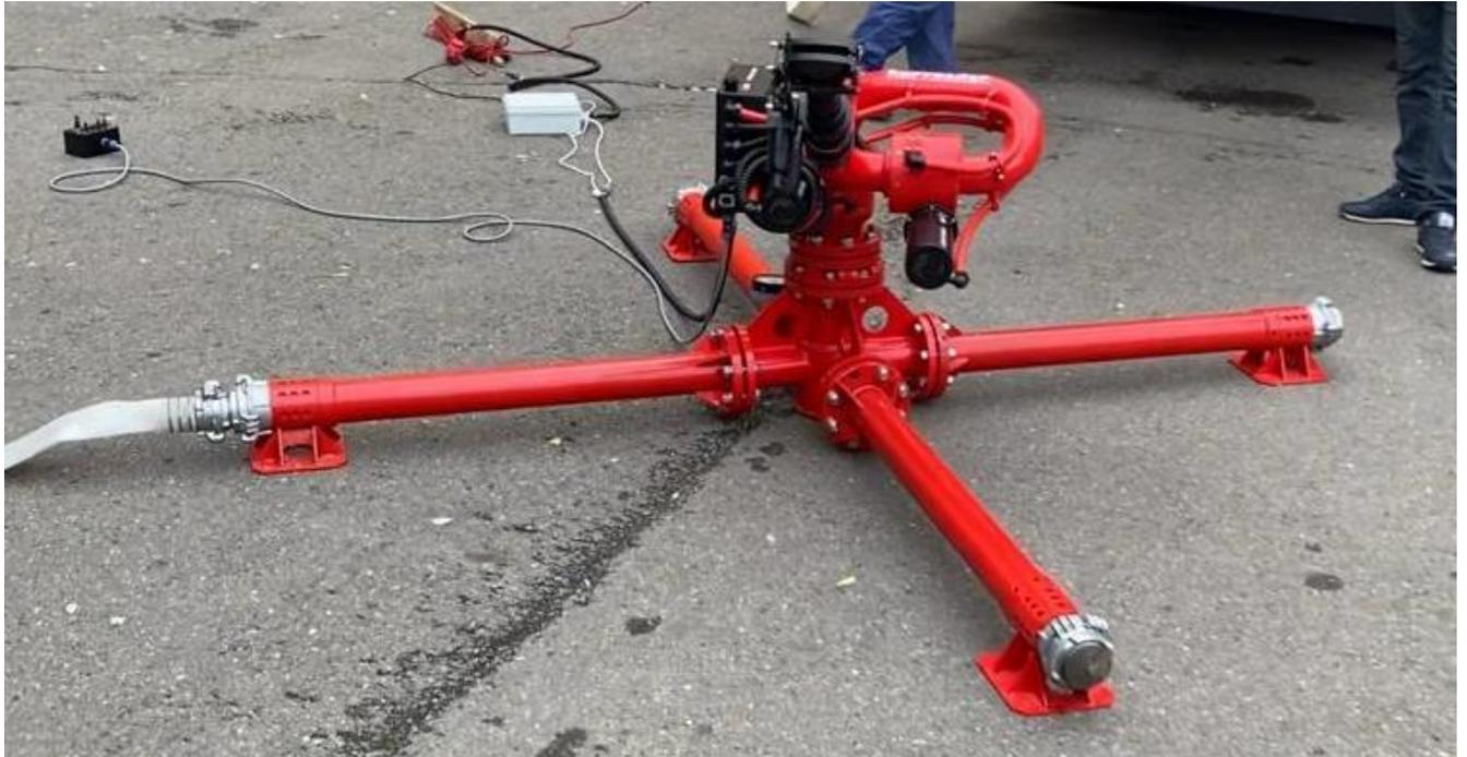
Рисунок 2.4 – Лафетный ствол, установленный на станине гидравлического стенда
