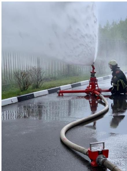
Рисунок 2.8 – Проливка экспериментального насадка
