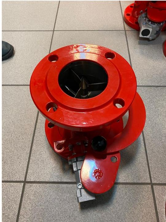
Рисунок 2.34 – Осциллирующее устройство закрытого типа
