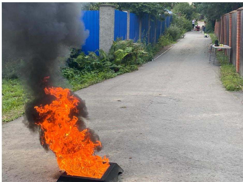
Рисунок 3.6 – Горение горючей смеси гептана и толуола
