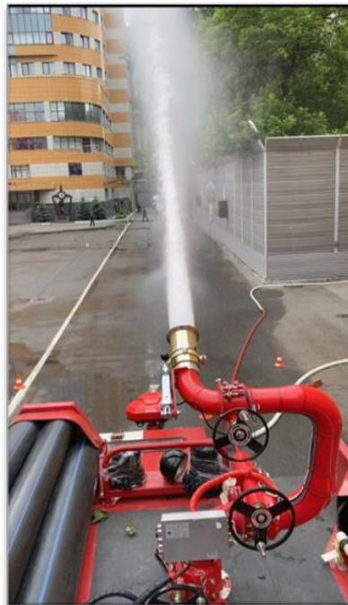
Рисунок 2.10 – Проведение испытаний по истечению ОТВ из универсального насадка лафетного ствола ООО «Уралмеханика»
