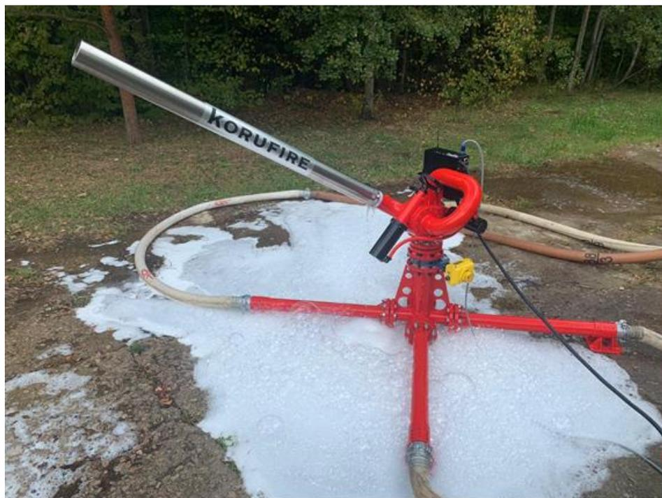
Рисунок 2.28 – Лафетный ствол с воздушно-пенным насадком, имеющим расход раствора пенообразователя 20 л/с
