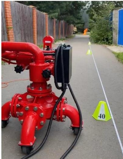
Рисунок 3.7 – Испытания роботизированного пожарного лафетного ствола с извещателем пламени
