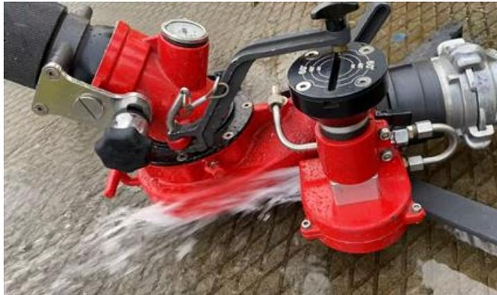
Рисунок 2.33 – Осциллирующее устройство открытого типа
