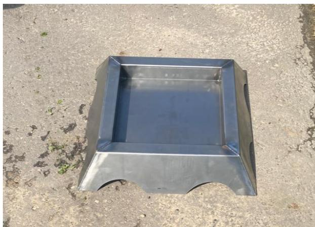
Рисунок 3.5 –Поддон для проведения огневых испытаний
