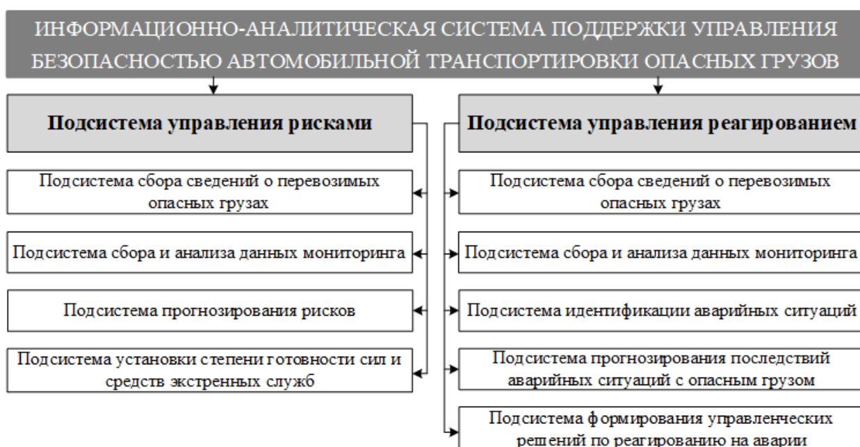
Рисунок 2.6 – Функциональная структура информационно-аналитической системы поддержки управления безопасностью автомобильной транспортировки опасных грузов
