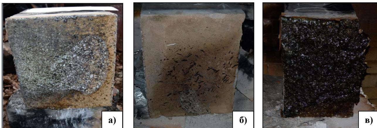
Рисунок 10 – Общий вид образцов на основе Б (а), ТБ (б) и ФТБ (в) после огневых испытаний при *HCOS*
