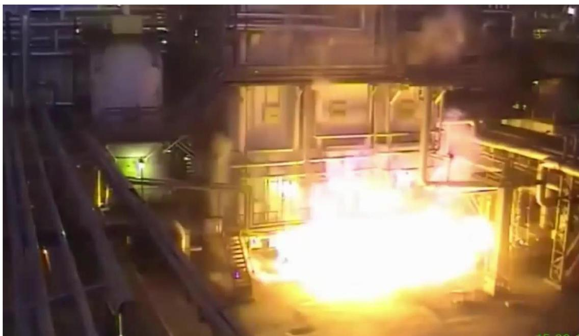
Рисунок 1.1 – Воспламенение газозвушной смеси от печи секции С-200
