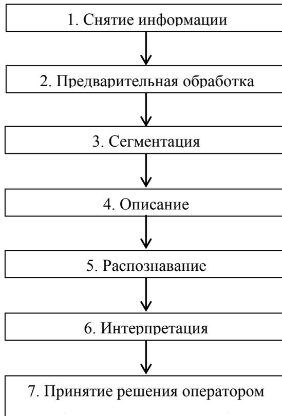
Рисунок 1.2 Алгоритм (этапы) типового процесса технического зрения в ИАС, учёт использования системы оператором
