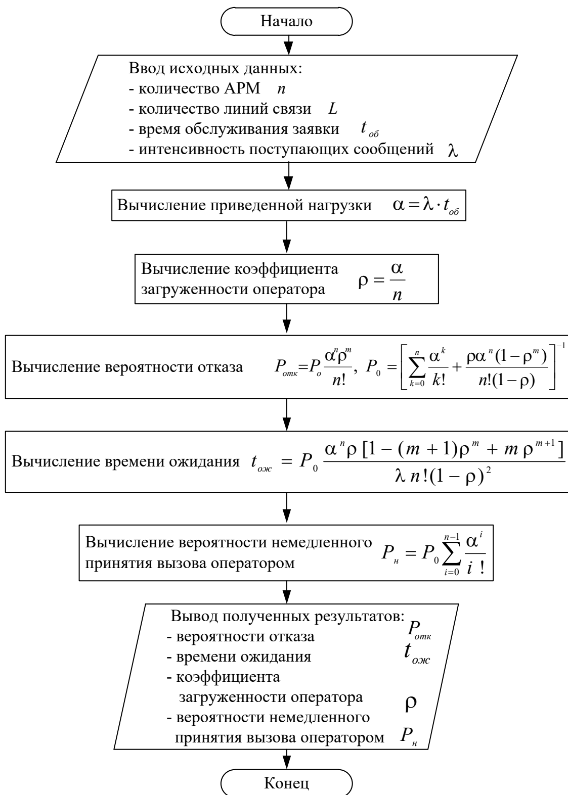
Рисунок 13 - Алгоритм решения задачи анализа ДДС при определении характеристик дежурно-диспетчерской службы
