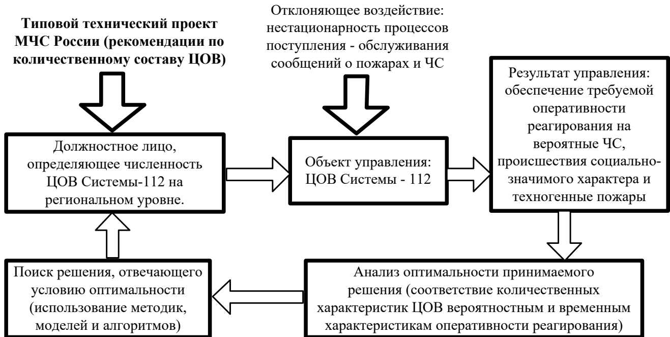
Рисунок 4 - Структурная схема поддержки принятия решения при управлении Системой-112 на региональном уровне
