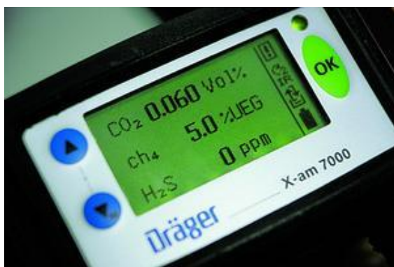
Рисунок 3.4 – Общий вид газоанализатора марки « Dräger X-am 7000 »: a – экран монитора; б – измерительное устройство
