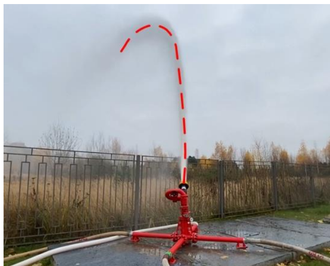
Рисунок 8 – Подаваемая струя при работе осциллирующего устройства с лафетным стволом
