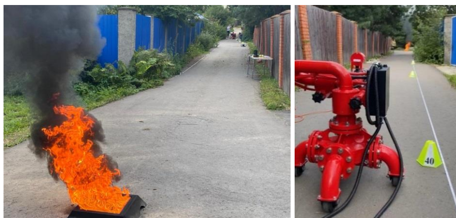
Рисунок 11 – Испытания роботизированного пожарного лафетного ствола с извещателем пламени
