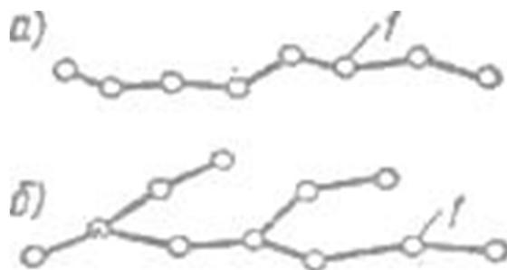
Рис. Схема строения макромолекулы полимера:
