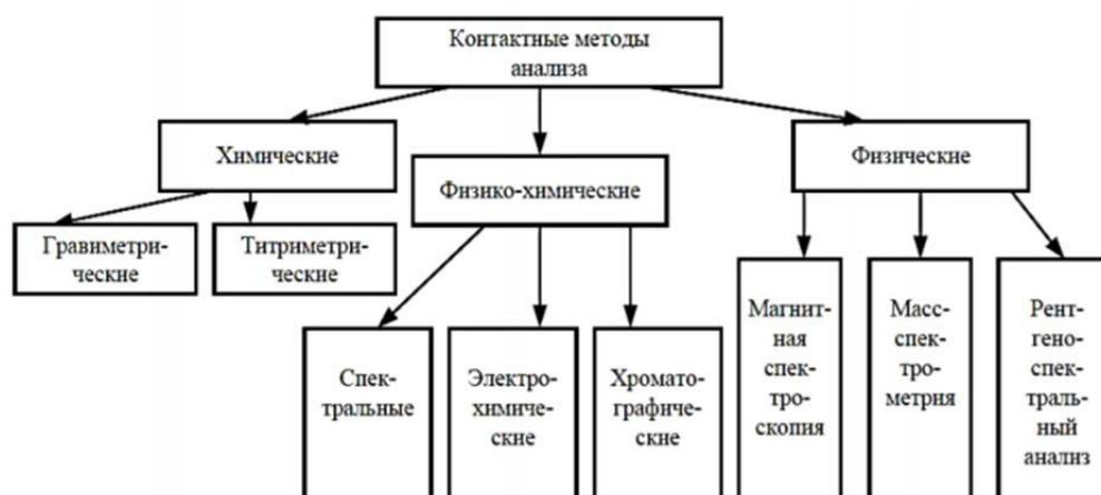
Рис. 1. Структура контактных методов наблюдения.
