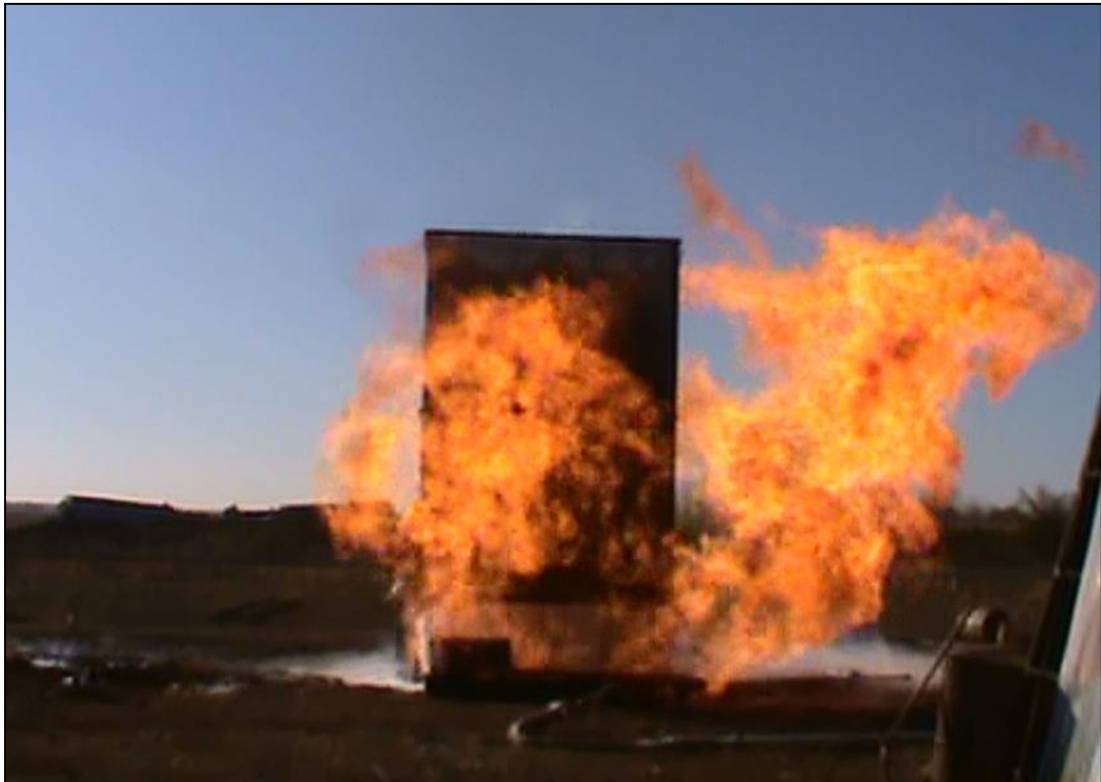
Рисунок 4.17 – Фрагмент воспламенения пролива СПГ в непосредственной близости от противопожарного устройства
