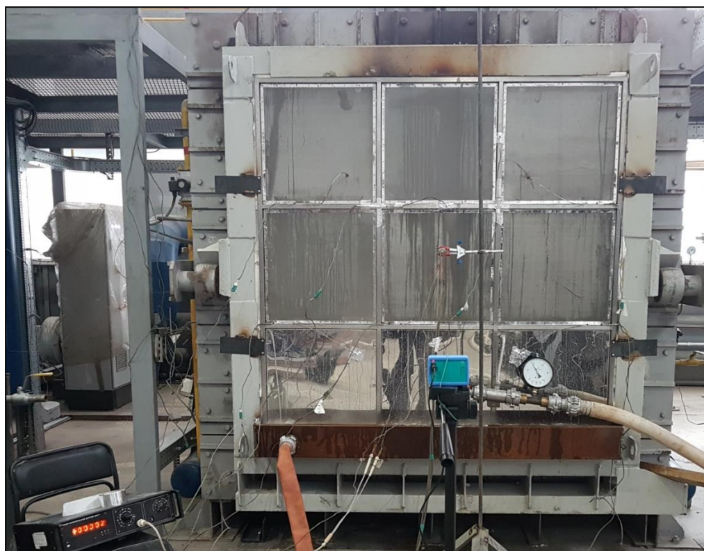
Рисунок 4.8 – Общий вид образца преграды до проведения испытаний
