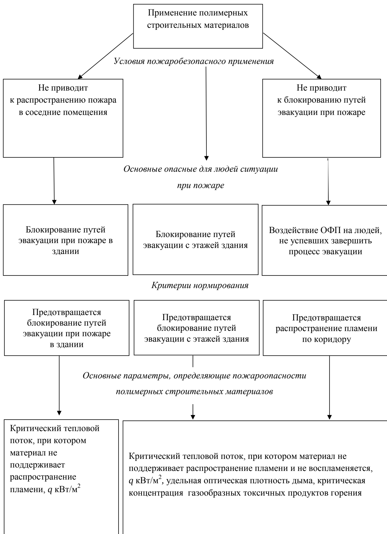
Рисунок 1.1 – Методологическая схема нормирования пожаробезопасного применения полимерных строительных материалов в зданиях [31, 76, 77]
