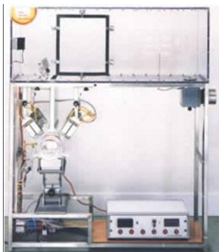
Рисунок 1.9 – Лабораторная установка ASTM E 1678 (NFPA 269) [100]
