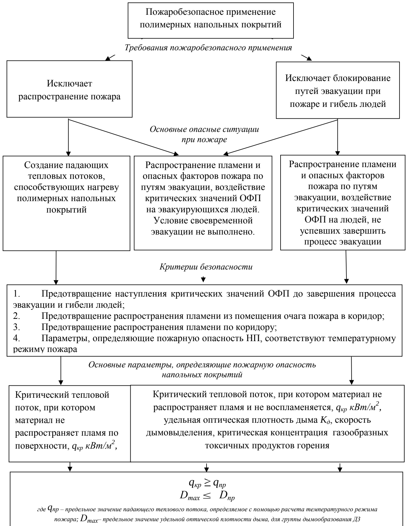
Рисунок 4.1 Методологическая схема пожаробезопасного применения полимерных напольных покрытий в зданиях с планировкой коридорного типа
