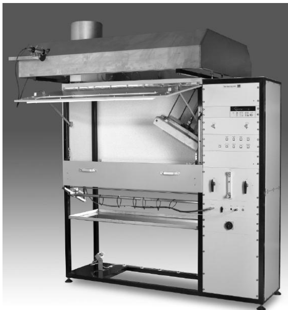
Рисунок 1.5 – Лабораторная установка для экспериментальной оценки способности напольных покрытий к распространению пламени по поверхности [158]
