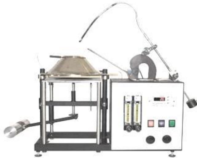
Рисунок 1.7 Лабораторная установка для экспериментальной оценки воспламеняемости по методу ISO 5657 [158]
