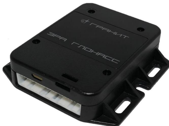
Рисунок. 2.1 – Абонентский телеметрический ГЛОНАСС/GPS/GSM терминал «Гранит-навигатор-6.18»
