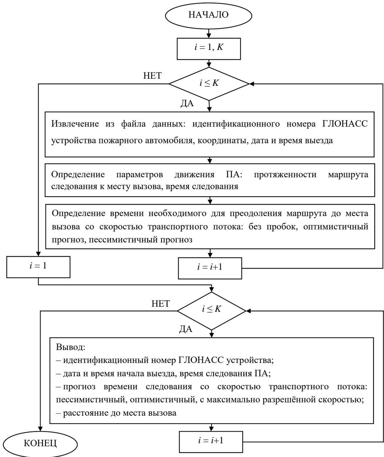
Рисунок 2.2 – Принципиальная блок-схема программа обработки и анализа ГЛОНАСС данных о следовании к месту вызова пожарно-спасательных подразделений:
