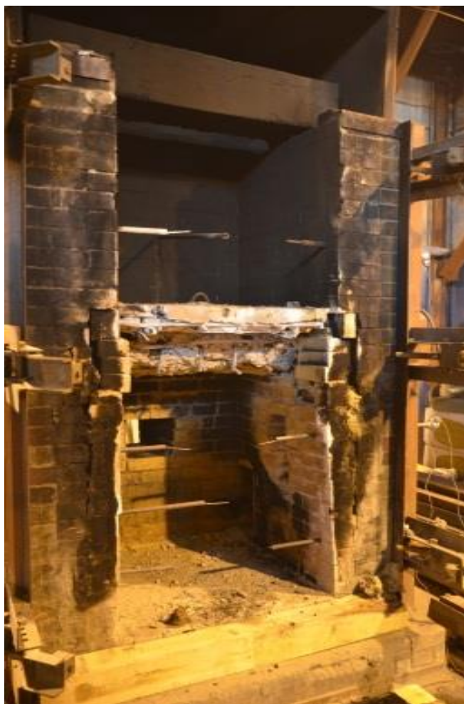
Рисунок 2.6 – Установка по оценке класса пожарной опасности строительных конструкций по ГОСТ 30403-2012 [120]
