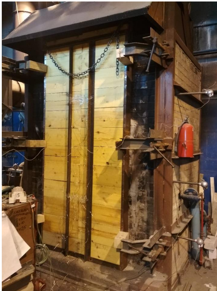
Рисунок 4.7 – Внешний вид ограждающей деревянной конструкции, установленной в испытательной печи
