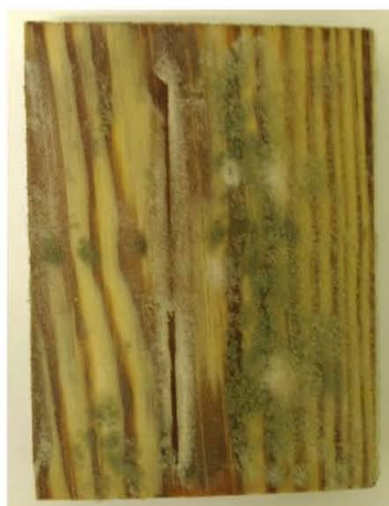
Рис. 2. Фрагмент контрольного образца не обработанной древесины после 15-ти дневной экспозиции в инфицированной среде.
