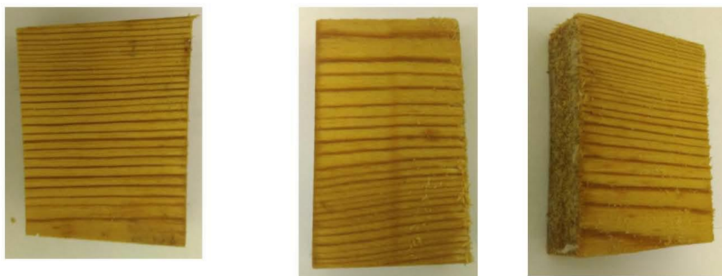
Рис. 3. Образцы древесины, пропитанный составом «Аммафон», после 15-ти дневной экспозиции в инфицированной среде
