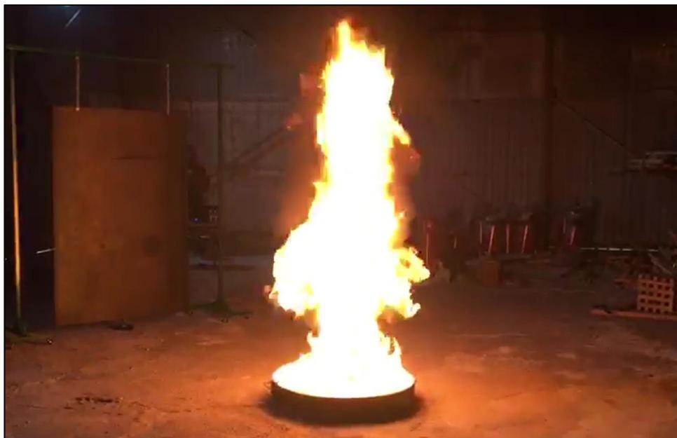
Рисунок 2.12 – Характерный контур пламени при горении бензина в противне, полученный в результате эксперимента
