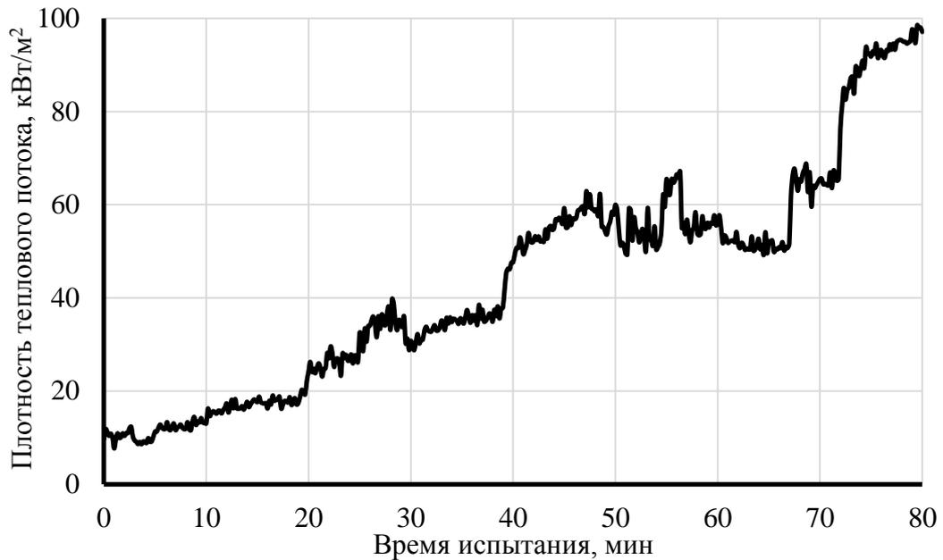
Рисунок 3.18 – Зависимость осредненной плотности теплового потока, падающего на обогреваемую сторону ВПЭ, от времени
