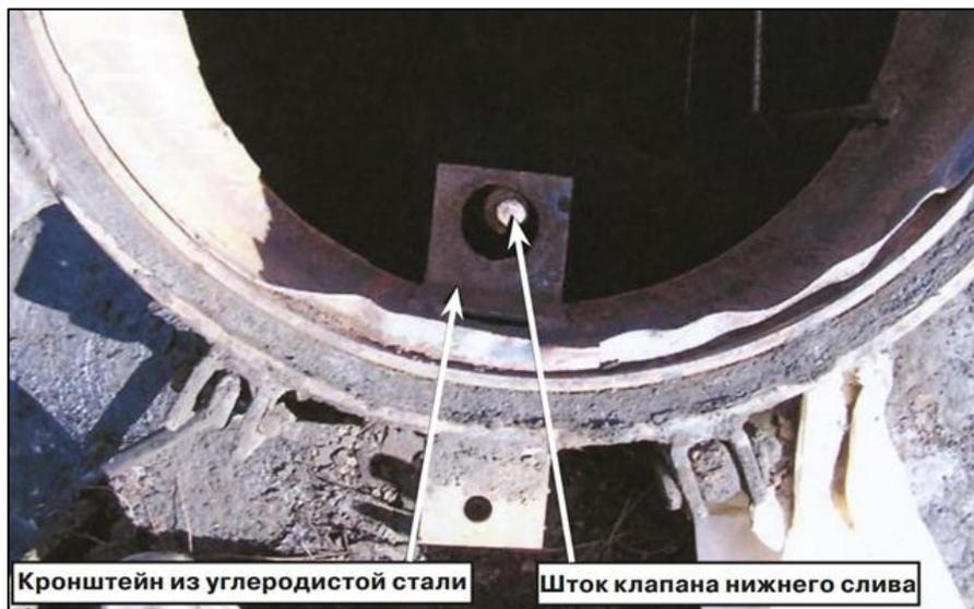
Рисунок 1.9 – Узел крепления штока для открытия клапана прибора нижнего слива с замененным наружным кронштейном
