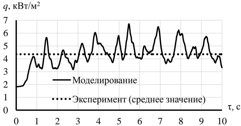
Рисунок 2.15 – Зависимость плотности падающего лучистого теплового потока от времени
