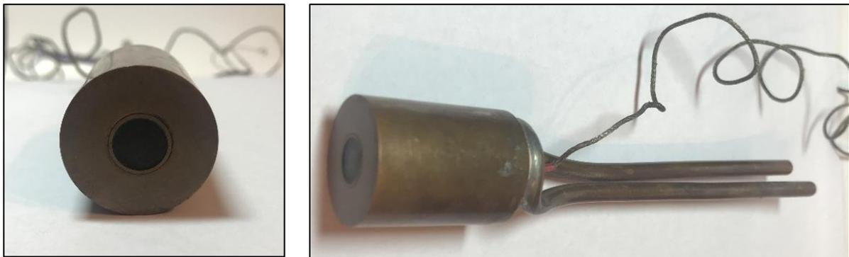
Рисунок 2.11 – Приемник теплового потока ПТП-2001 (датчик Гордона)
