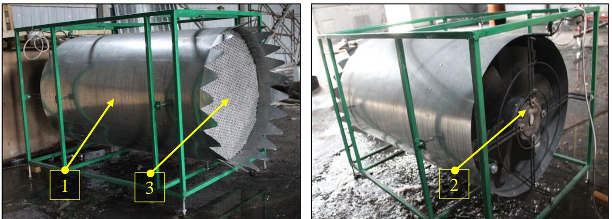
Рисунок 3.8 – Установка для создания стационарного ветрового воздействия:
