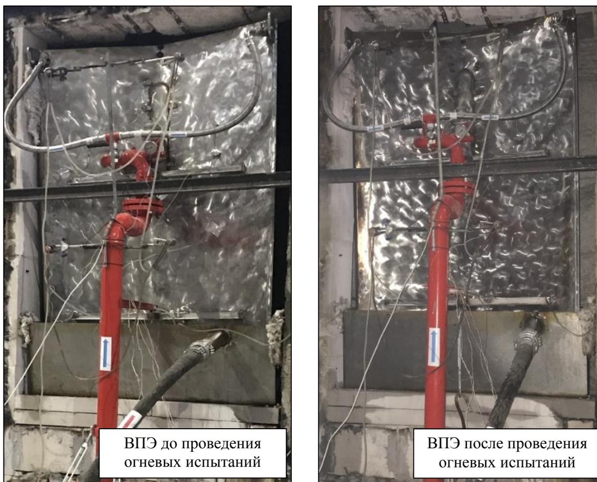
Рисунок 3.22 – ВПЭ до и после проведения огневых испытаний
