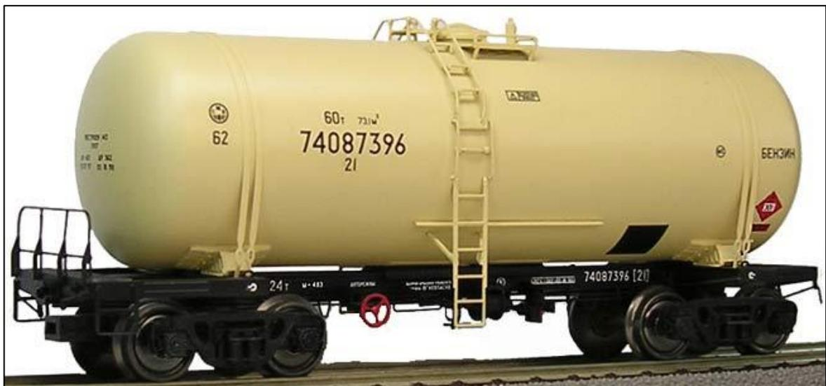
Рисунок 1.5 – Четырехосная цистерна для перевозки бензина и светлых нефтепродуктов (модель 15-1443):
