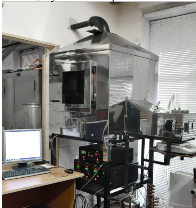
Рисунок 2 – Общий вид установки для определения пожарной опасности веществ и материалов при их термическом разложении
