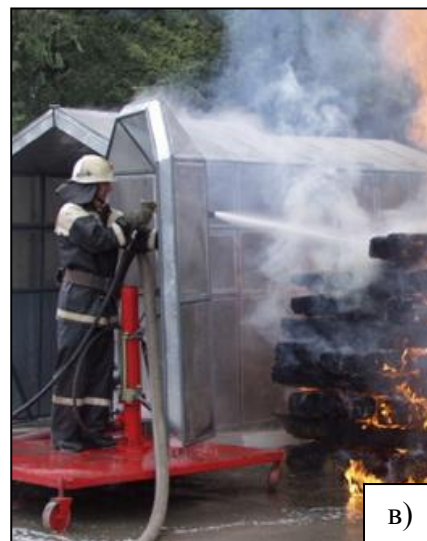
Рисунок 13 – Общий вид моделей теплозащитных экранов для защиты личного состава пожарной охраны: а) «Согда» 1А.01; б) «Согда» 1В; в) «Согда» 2А
