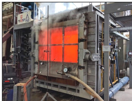
Рисунок 7 – Фрагмент испытаний образца преграды на огнестойкость
