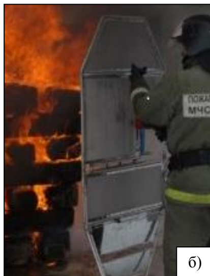
Рисунок 13 – Общий вид моделей теплозащитных экранов для защиты личного состава пожарной охраны: а) «Согда» 1А.01; б) «Согда» 1В; в) «Согда» 2А
