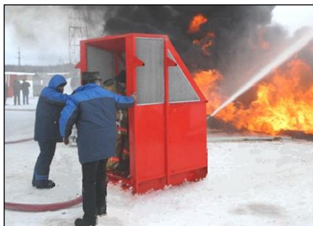
Рисунок 16 – Общий вид укрытия на основе экранов «Согда» 4 для защиты персонала от поражения обломками оборудования
