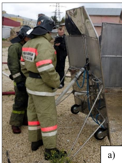
Рисунок 13 – Общий вид моделей теплозащитных экранов для защиты личного состава пожарной охраны: а) «Согда» 1А.01; б) «Согда» 1В; в) «Согда» 2А
