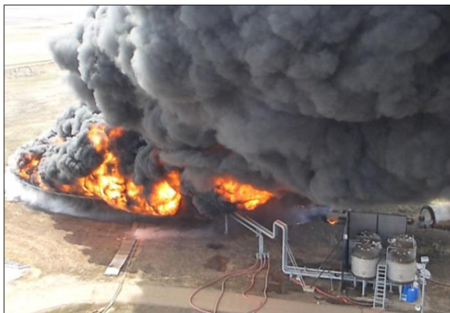
Рисунок 11 – Применение противопожарной преграды «Согда» для защиты емкостей с тушащим веществом от тепловых потоков горящего бензина в резервуаре объемом 20000 м 3 (полигонные испытания)
