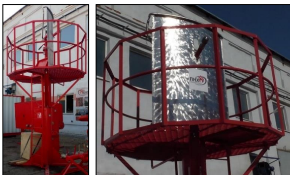
Рисунок 18 – Общий вид водопленочного защитного экрана в составе лафетного пожарного комплекса
