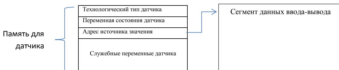
Рис. 3.2 Блок памяти с данными технологического датчика.
