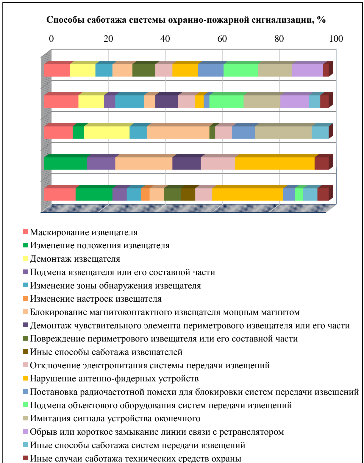
Рисунок 2.9 – Относительное количество различных способов саботажа средств сбора и обработки данных в зависимости от категории охраняемого объекта
