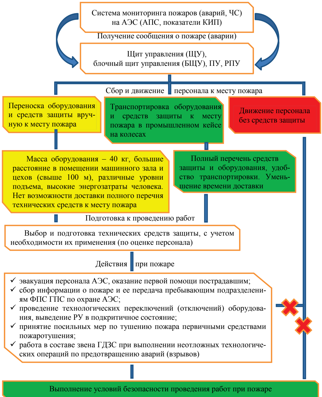
Рисунок 3.24 – Модель действий оперативного персонала в случаях возникновения пожаров в помещениях АЭС
