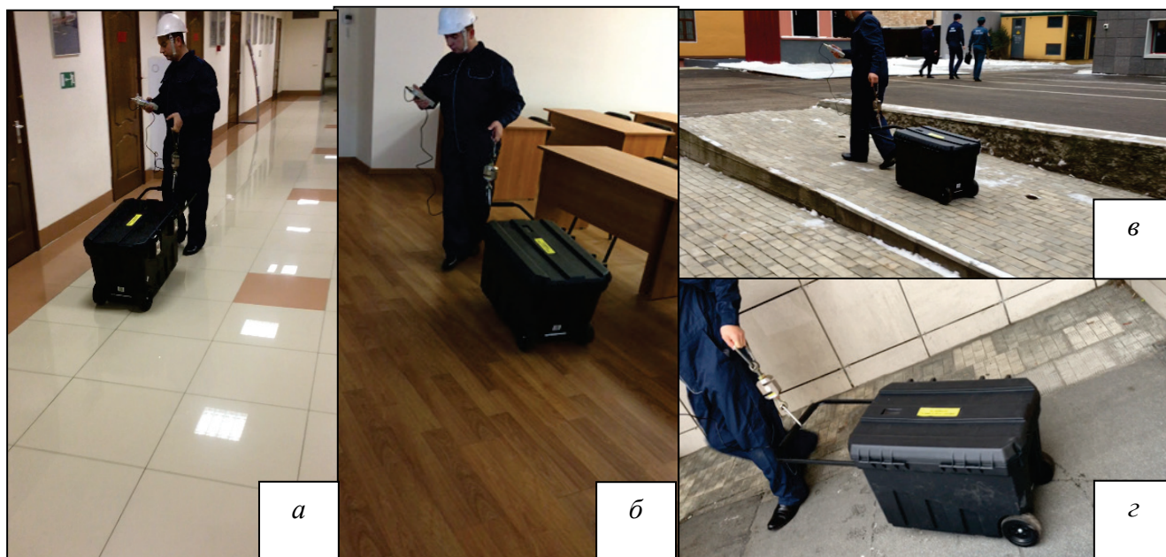
Рисунок 3.30 – Измерение силы, необходимой для транспортировки комплекта по различным поверхностям: а – керамогранитная плитка; б – ламинат; в – брусчатка; з – асфальт
