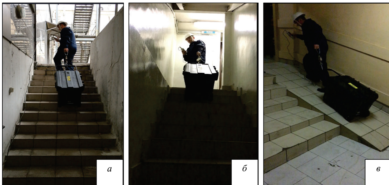
Рисунок 3.32 – Измерение силы, необходимой для транспортировки передвижного комплекта по железобетонным лестницам и пандусу с углом наклона:
