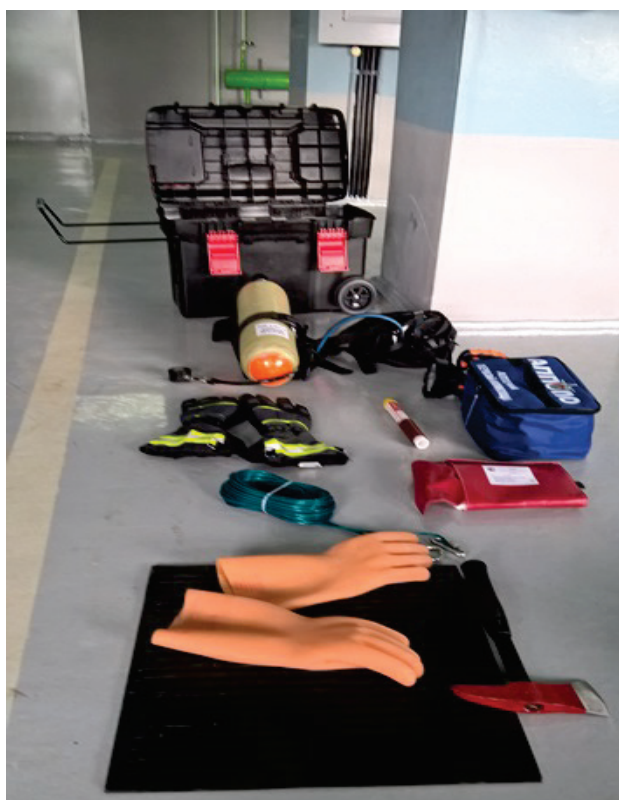
Рисунок 3.1 – Прототип передвижного комплекта технических средств для обеспечения действий оперативного персонала при возникновении пожаров в помещениях атомных электростанций
