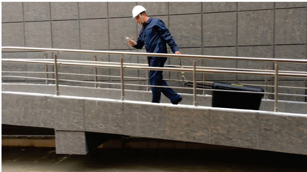
Рисунок.3.29 – Измерение силы, необходимой для транспортировки передвижного комплекта по плиточной поверхности пандуса с углом наклона 10^{\circ}
