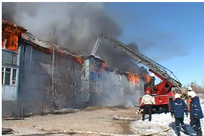
Рисунок 3.3 – Фрагмент процесса тушения пожара в здании сборно-щитовой конструкции серии «БАМ» с применением АЛ-30 для подачи ОТВ в зону горения (г. Ноябрьск, 2008 год)
