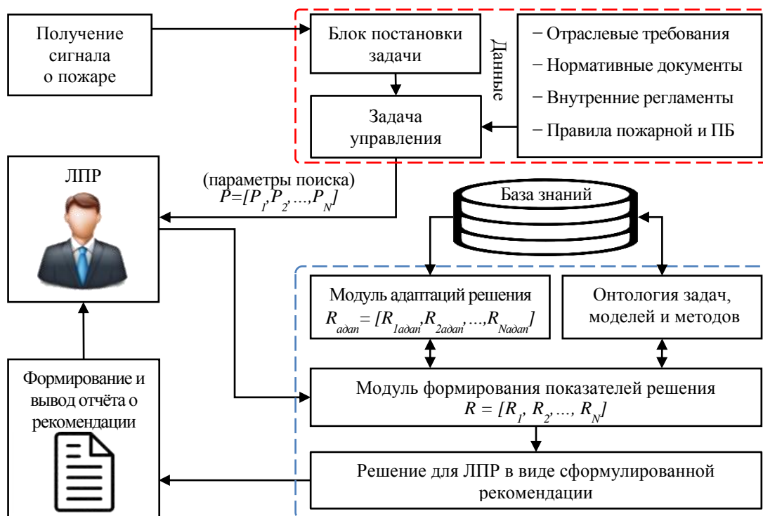
Рисунок 3.1 – Функциональная схема системы поддержки управления для прогнозирования ресурсов пожарно-спасательных подразделений при реагировании на пожары объектов нефтепереработки
