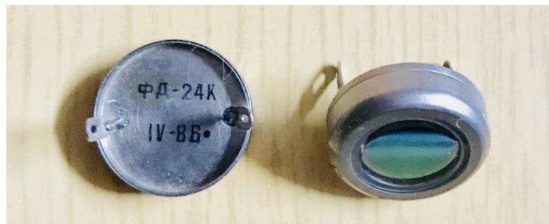
Рисунок 3.3 – Внешний вид фотодиода ФД24К (ФД-7К) [34]
