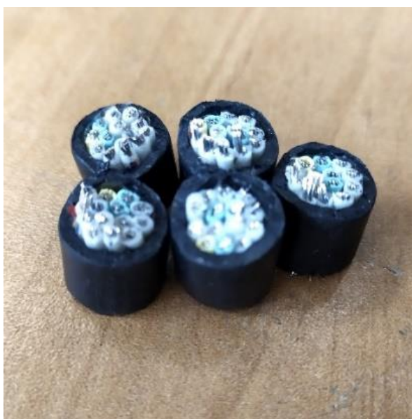
Рисунок 4.1 – Сечение кабеля ВВГнг [105]
