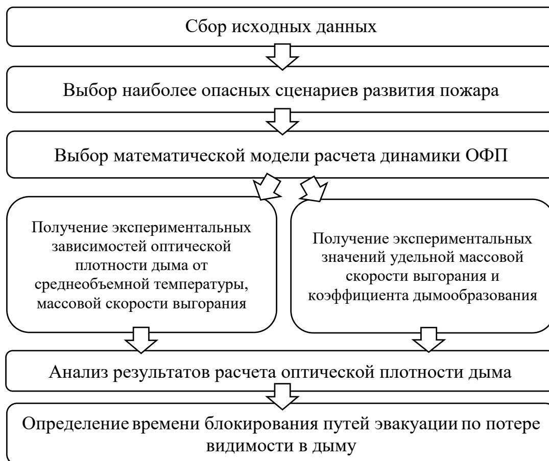
Рисунок 2.3 – Блок-схема методики расчета потере видимости в дыму при пожаре на объекте энергетики
