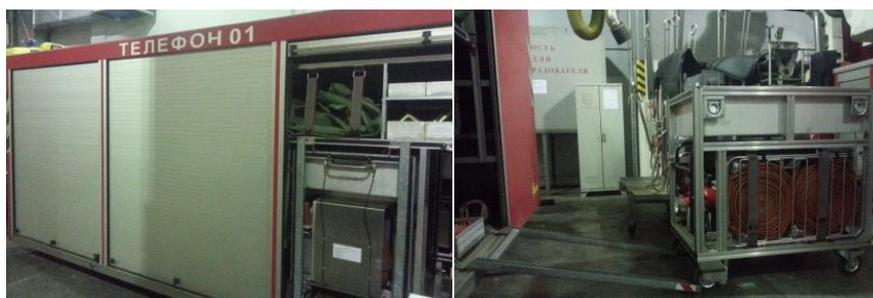
Рисунок 3.1 – Мобильные контейнеры с пожарно-техническим оборудованием
