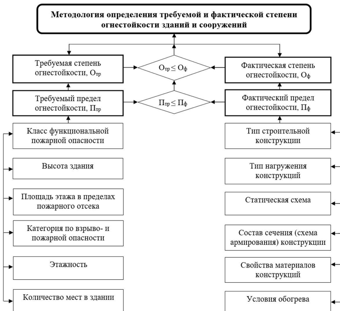
Рисунок 1.15 – Методология определения требуемых и фактических пределов огнестойкости ЗиС
