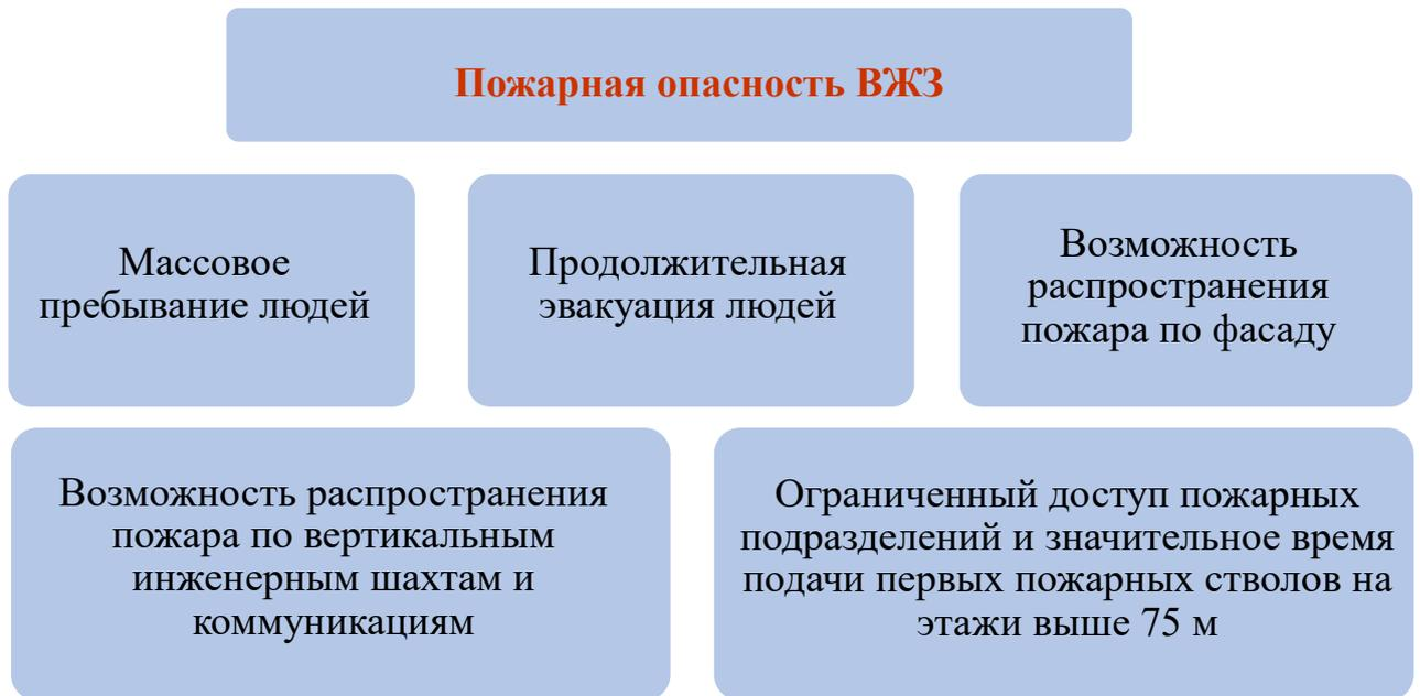
Рисунок 1.4 – Пожарная опасность ВЗ
