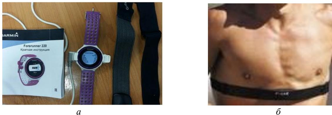
Рисунок 4.7 – Устройство «Garmin Forerunner 220» (а) для замера ЧСС сокращений и его крепление на пожарных-спасателях (б)
