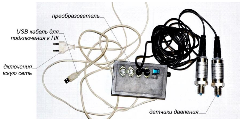
Рисунок 7 – Техническое обеспечение системы мониторинга давления: адаптер, датчики давления
