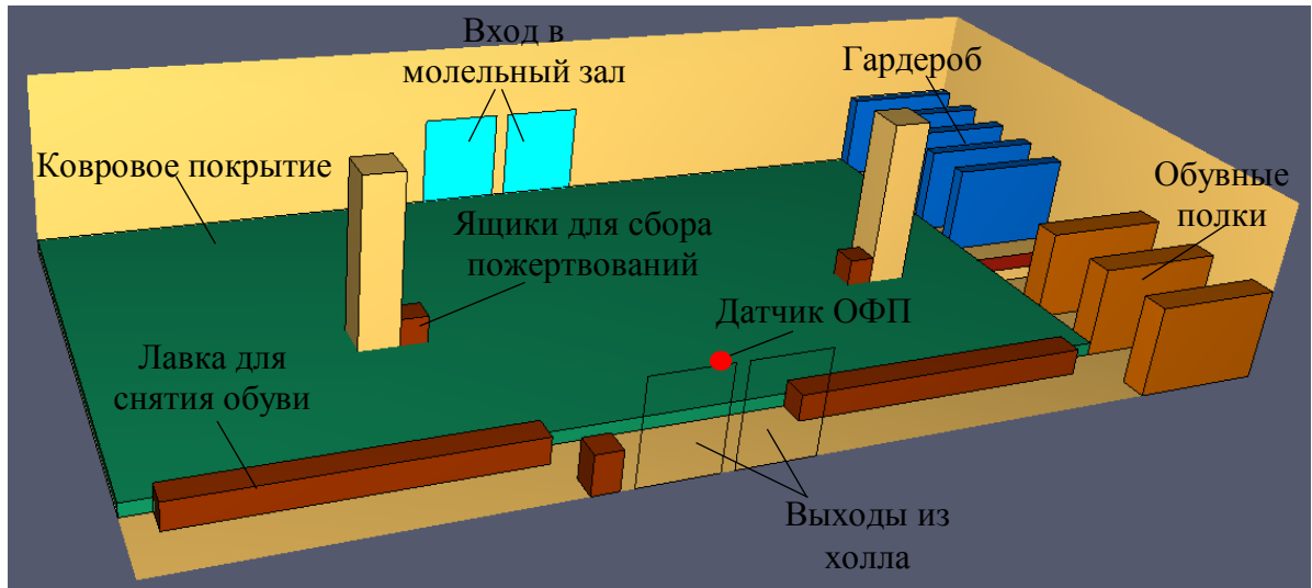
Рисунок 4.8 – Трехмерная модель холла мечети с необходимой пожарной нагрузкой
