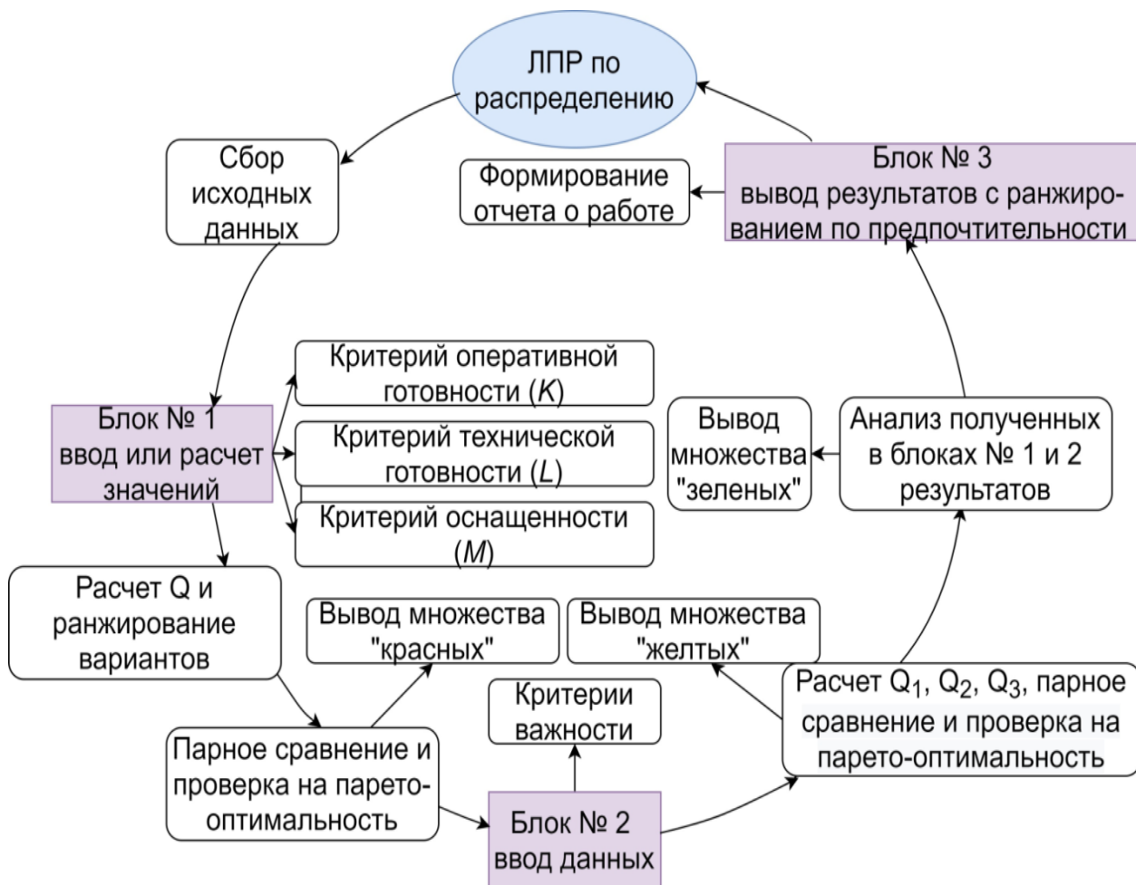
Рисунок 7 – Модель поддержки управления распределением пожарных автомобилей
